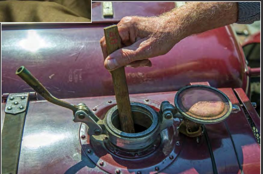
Der Spritstand im Tank dieses Alvis Speed wird per Holzstab gemessen, weil die Tankuhr defekt ist.
