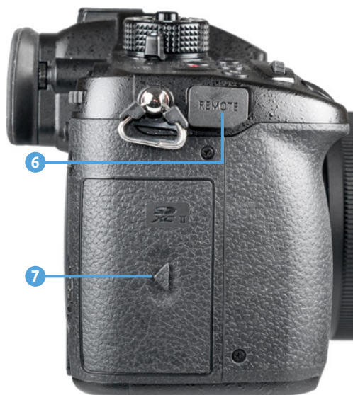
▲ Die Anschlussbuchsen der GH5 auf der von hinten betrachtet rechten Seite.
