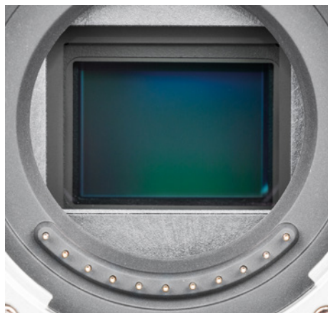
▲ Bei abgesetztem Objektiv ist der Sensor der GH5 zu sehen (17,3 × 13 mm, MFT-Format, Cropfaktor 2, natives Seitenverhältnis 4:3).
