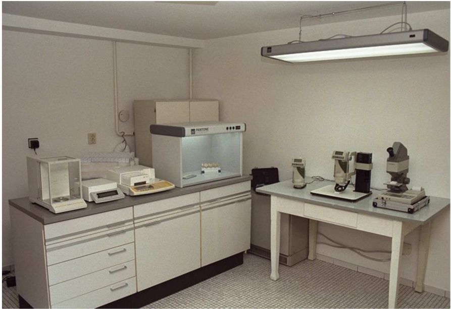
Abb. 1 Versuchsanordnung von links nach rechts: Mikrowaage MC21S, Sartorius Moisture Analyzer MA100, Lichtkabine, Farbprüfleuchte (oben), Spektrophotometer CM-503i, Spektrophotometer CM-503c und mikroskopisches Chromameter CR-241.
