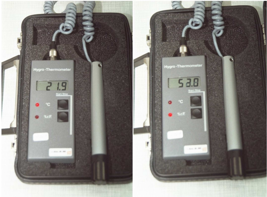
Abb.3.2-1 Elektronisches Hygro-Thermometer (Firma Thies Clima, Göttingen/Deutschland) zur Raumüberwachung der Temperatur in Grad Celsius (links) und Luftfeuchtigkeit in % (rechts).
