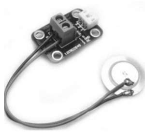
Figura 1.7 Ejemplo de sensor piezoeléctrico para vibraciones.
