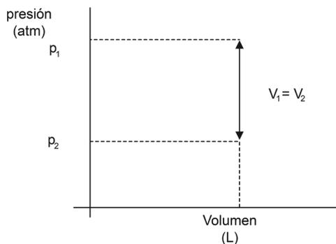
**Figura 1.6.** Diagrama termodinámico para un proceso a volumen constante (isométrico).
