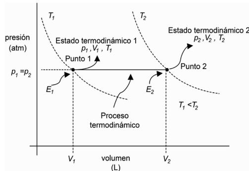
**Figura 1.2.** Diagrama energético de un sistema termodinámico.
