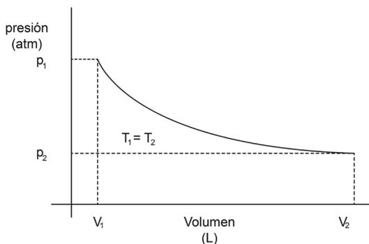
**Figura 1.5** Proceso termodinámico a temperatura constante (isotérmico) en un diagrama  $pV$ .
