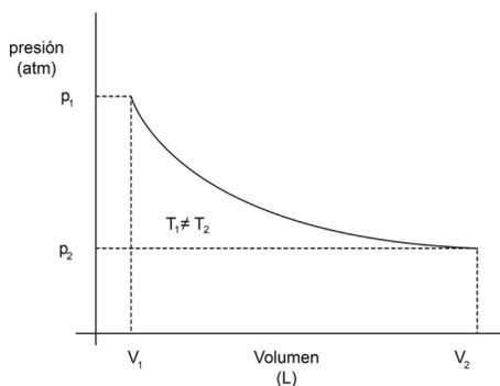
**Figura 1.7.** Diagrama que indica el comportamiento para un proceso adiabático.
