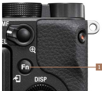
Abbildung 1.12: Schnell auf wichtige Funktionen zugreifen: Das gelingt Ihnen mit der »Fn«-Taste 1 (Bild: Sony).
