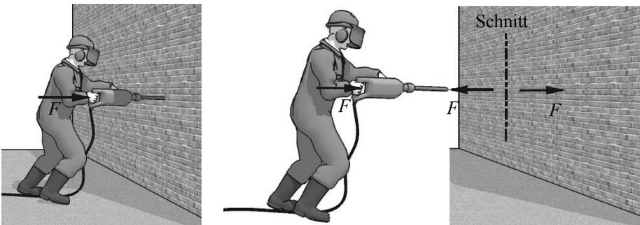
Abb. 1.1.6: Zum Wechselwirkungsgesetz, *actio = reactio-Prinzip*.
