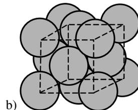
**Bild 1.1-10** Kubisch-flächenzentriertes Gitter (kfz)
