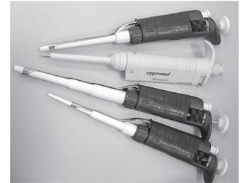
*Mikropipetten zur Dosierung kleinster Volumina*
