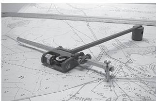
Der Flächeninhalt unregelmäßig berandeter Flächen lässt sich mit einem Polarplanimeter ermitteln. Beim Umfahren der Flächenberandung läuft eine Messrolle mit und gibt über ein Zählwerk den Inhalt der umfahrenen Fläche an.
