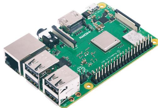
Abbildung 1.1: Der Raspberry Pi (Model 3B+) ist ein vollwertiger Rechner im Kreditkartenformat (Quelle: Reichelt).
