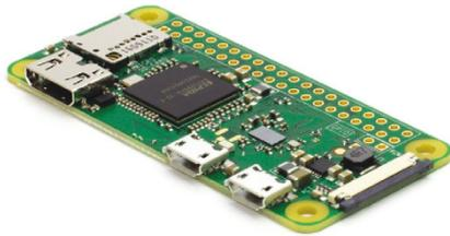
Abbildung 1.4: Der Raspberry Pi Zero W (Quelle: Pimoroni).
