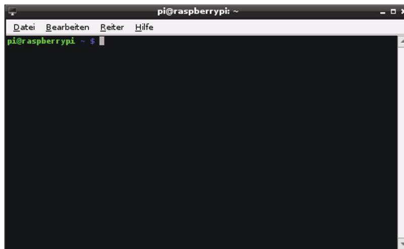
Abbildung 1.13: Das LXTerminal ist eine Konsole zur Kommandoeingabe
