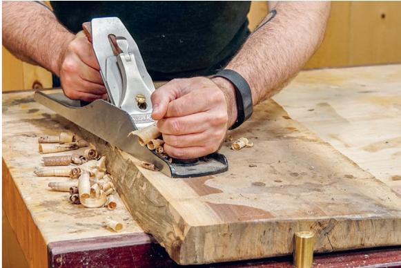
**2 Mit dem Abrichten beginnen.** Da meine Bohle so verzogen ist, dass sie nicht plan auf dem Arbeitstisch der Dickenhobelmaschine liegt, nehme ich die höheren Stellen mit einem Hobel ab, bis das Kipplern verschwindet. Je nach Bohle, die Sie verwenden, kann das ebenfalls notwendig sein oder entfallen.
