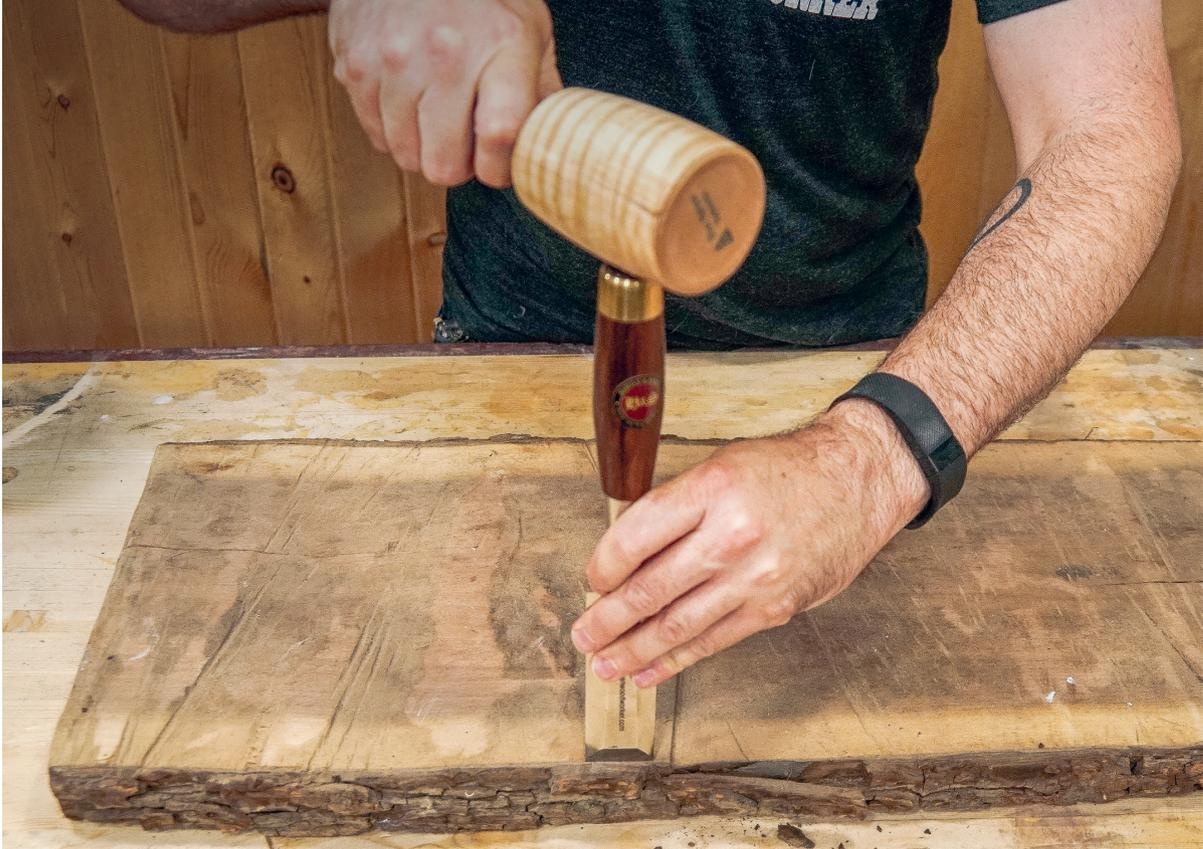
**1 Mit einer Bohle anfangen.** Diese 280 mm breite Nussbaumbohle war grob mit der Kettensäge zugeschnitten (sie stammte von einem Baum, der bei meinem Elternhaus gestanden hatte, und war einige Jahre natürlich getrocknet). Entfernen Sie die Rinde vollständig mit einem Stechbeitel und Klüpfel, lassen Sie aber die natürliche Unregelmäßigkeit der Baumkante am Splintholz stehen.
