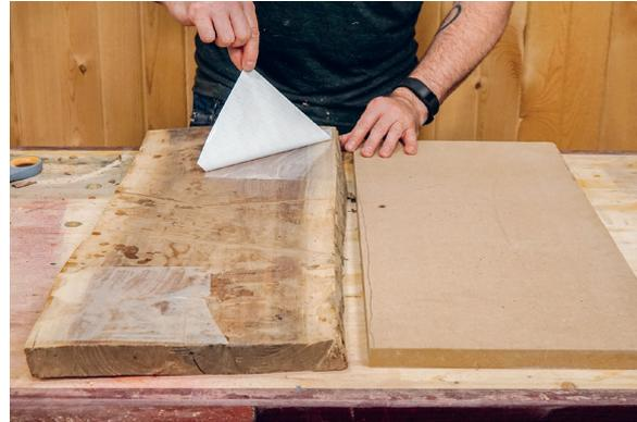
**3 Sie benötigen vielleicht ein Unterlegbrett.** Falls Sie an der Bohle mit einigen Stößen des Hobels hochstehende Stellen abnehmen mussten, legen Sie doppel-seitige Klebefolie auf die gehobelten Stellen. Befestigen Sie dann die Bohle auf einem Unterlegbrett, um es durch die Dickenhobelmaschine schieben zu können.
