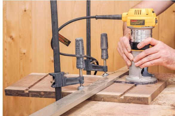
**7 Nuten für die Füße fräsen.** Markieren Sie die Lage der Füße in etwa 50 mm Entfernung von den Enden des Bretts. Spannen Sie dann ein Richtschieß so über das Material, dass der Fräser an der gewünschten Stelle schneidet, wenn die Handoberfräse am Richtschieß entlang geführt wird. Schneiden Sie dann an jeder Seite eine 6 mm tiefe Nut parallel zu den Enden des Bretts.
