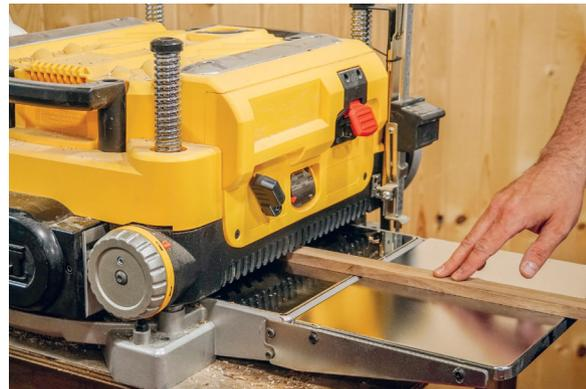
**9 Auf Maß hobeln.** Hobeln Sie die beiden Fußleisten in der Dickenhobelmaschine auf Maß. Entfernen Sie in mehreren Durchgängen so viel Material, dass Sie eine enge Passung in den Nuten an der Unterseite des Schneidbretts erzielen.
