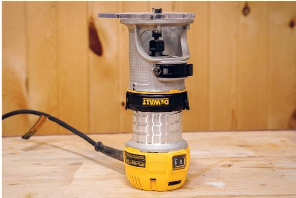
**6 Handoberfräse bereitmachen.** Spannen Sie einen 12-mm-Nutfräser in die Handoberfräse ein, um die Nuten zu schneiden, die als Aufnahme für die Füße des Schneidbretts dienen.
