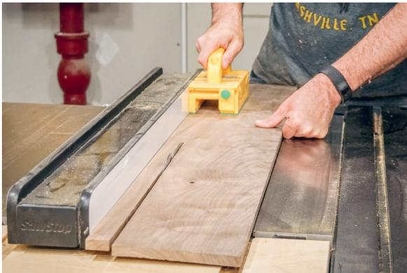
**8 Füße zuschneiden.** Schneiden Sie an der Tischkreissäge zwei Nussbaumleisten mit 25 mm Breite für die Füße zu.
