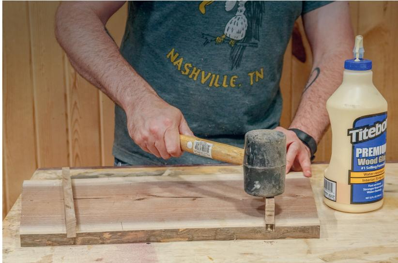
**11 Füße anbringen.** Geben Sie eine Leimschnur in die Nuten und stecken Sie dann die Fußleisten in die Nuten. Wenn die Passung sehr eng ist, können Sie die Leisten mit einem Klüpfel einklopfen, um sicherzustellen, dass sie auf dem Grund der Nuten aufliegen. Wenn die Passung sehr schön eng ist, muss man die Verleimung nicht mit Zwingen einspannen.
