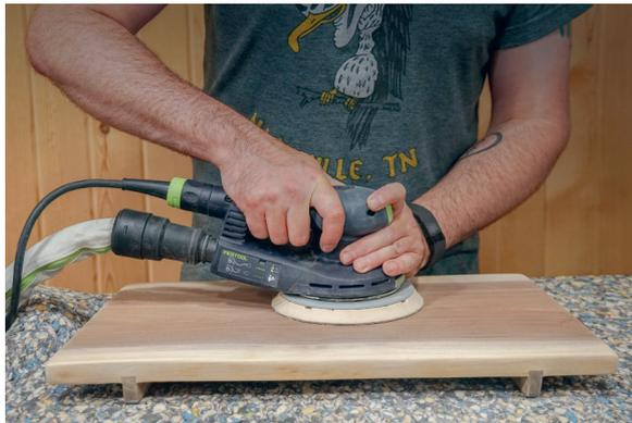
**12 Glatt schleifen.** Schleifen Sie sowohl die Flächen als auch die Kanten des Schneidbretts glatt. Arbeiten Sie sich bis mindestens zu einer 220er Körnung hoch. Achten Sie darauf, dass an den Längskanten alle Rindenreste abgeschliffen sind, sodass das hellere Splintholz zum Vorschein kommt.
