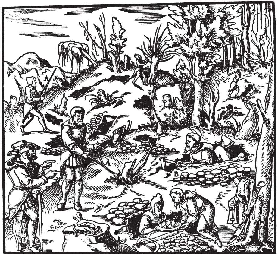
FIGURA 1.1 Exploración en busca de yacimientos con un palo en forma de horquilla (A) y abriendo pozos (B) en el siglo XV. (De Agrícola, De Re Metallica , traducido al inglés por Dover Publications, New York, 1950.)
