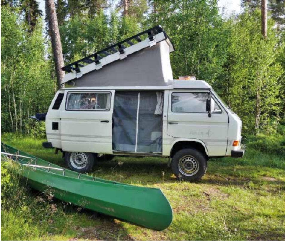
stangen unterfahren, die Reisemobile von vielen Parkplätzen aussperren. Allerdings bestehen die Seitenwände des Aufstelldachs aus dünnem Stoff und bieten kaum Wärmedämmung.
