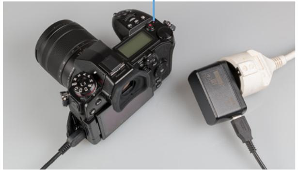
▲ Aufladen des Akkus in der G9 über das USB-Anschlusskabel und den Netzadapter am Stromnetz.
