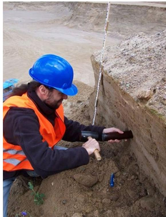
**Abb. 1.10** Probennahme für die OSL-Datierung. Die Probe wird mittels einer lichtdichten Röhre aus der Aufschlusswand entnommen, da jeder Lichteinfall auf die Probe vermieden werden muss. Die Proben werden erst im „Dunkellabor“ bei Rotlicht aus der Röhre entnommen. (Foto: Wenske)
