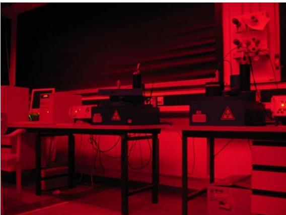
**Abb. 1.9** Lumineszenz-Messgeräte im Datierungslabor des LIAG in Hannover. Das Arbeiten erfolgt unter Rotlicht, um Belichtungen der Proben zu vermeiden. (Quelle: M. Frechen)
