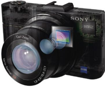
geführt, er wird rückwärtig belichtet. Beim herkömmlichen Sensordesign werden die Leiterbahnen nach vorne weggeführt, die Leitungen liegen also vor der lichtempfindlichen Schicht. Nicht so beim BSI-Wandler der RX100 II – hier wird das Signal nach hinten weggeleitet, keine Leitungen stören das Licht auf seinem Weg in die Tiefen des Siliziums. Sony reklamiert, dass der neue
