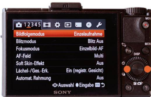
2. Um vertikal durch die Menüs bzw. Register eines Menüs zu blättern, drücken Sie die ◀- bzw. ▶-Taste auf dem Steuerrad. Hier bin ich so ins Menü 2 weitergegangen:
