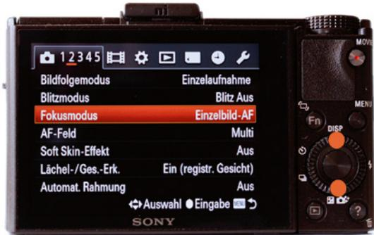
4. Sie rufen die aktuell markierte Option auf, indem Sie die zentrale SET-Taste drücken. Ihre RX100 blendet daraufhin eine Auswahlliste ein, in der Sie wieder mit ▼ bzw. ▲ die gewünschte Einstellung wählen – hier *AF-C*. Alternativ drehen Sie am Steuerrad, bis die gewünschte Einstellung markiert ist.
