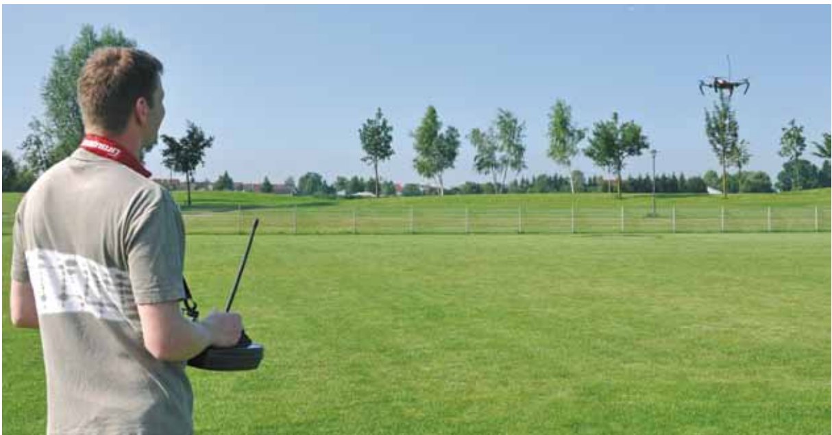
Bild 15.7 – Mit zunehmender Sicherheit können Sie Schweberversuche auch in größeren Höhen wagen. Fliegen Sie dabei stets so, dass Sie auf die Rückseite des Quadrocopters sehen.
