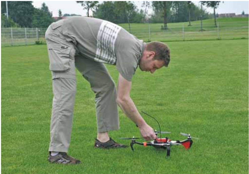
Bild 15.2 – Stellen Sie den Quadroko­pter so vor sich auf, dass Sie ihn von hinten sehen. Die mit einer roten Kunststoff­fahne markierte Vorderseite zeigt dabei von Ihnen weg.
