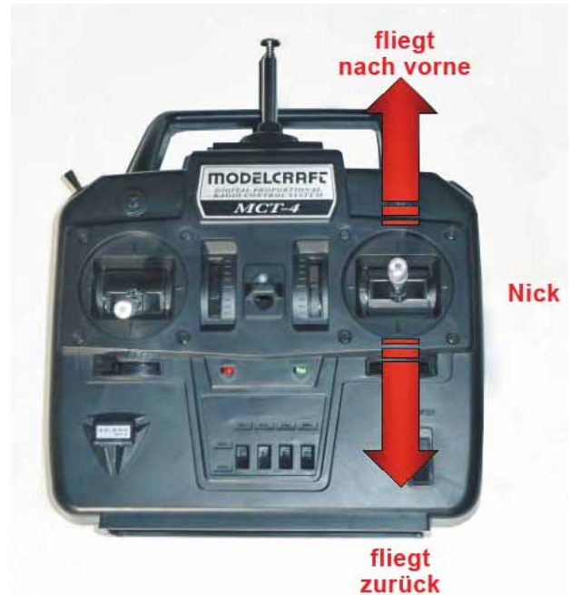
Bild 5.4 – Mit der Nick-Funktion kann man den Quadrocopter vor- und zurückfliegen lassen. Dazu ist im Mode 2 der rechte Steuerknüppel auf- oder abzubewegen.
