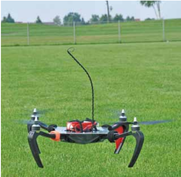
Bild 15.4 – Während der ersten Schweberversuche sollte man nur knapp über dem Boden fliegen. Das erleichtert das Landen und hilft im Ernstfall, größere Schäden zu vermeiden.
