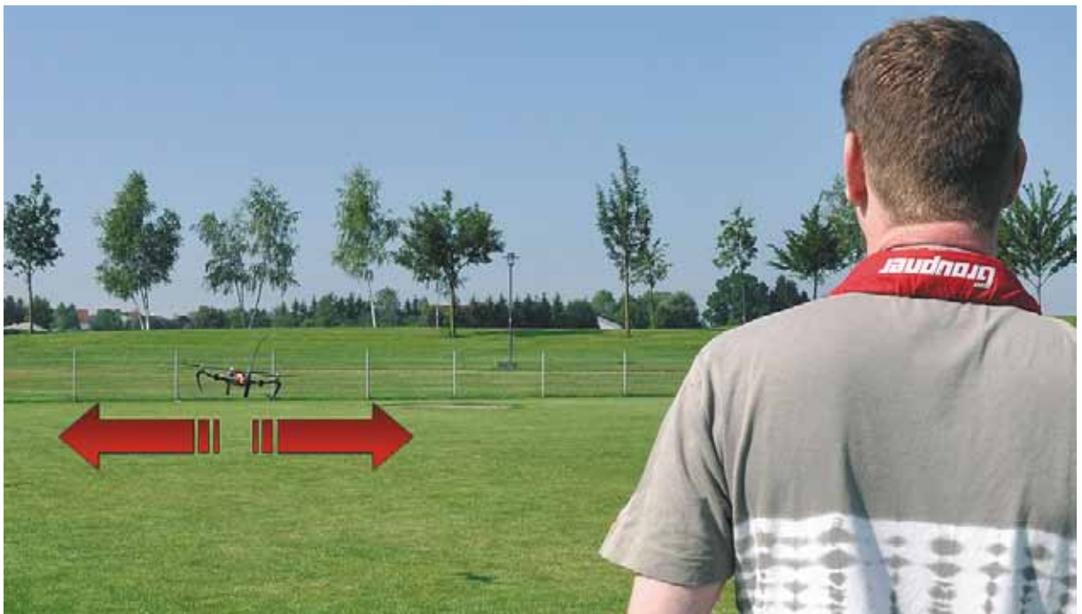
Bild 15.8 – Zum gewünschten seitlichen Abdriften ist die Roll-Funktion mit dem rechten Steuerknüppel auszuführen.
