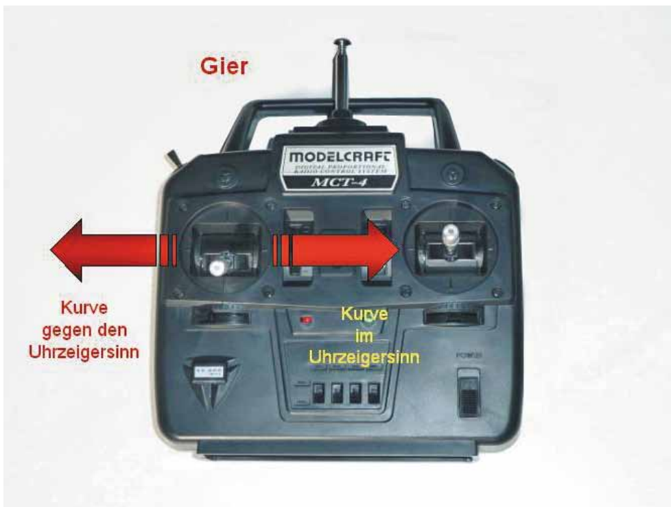
Bild 5.3 – Durch Bewegen des Knüppels nach links oder rechts wird Gier ausgeführt. Damit ändern Sie die Flugrichtung des Quadropters.
