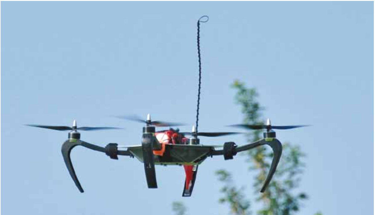
Bild 15.6 – Durch Geben von Nick entgegen der Flugrichtung lässt sich die Geschwindigkeit des Quadropters abbremsen.
