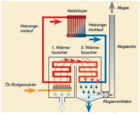
Abb. 4.1 - Heizen mit Brennwert - Schema; (Quelle: Zehnder Gmbh, Lahr)
