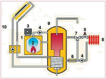
**Abb. 1.5** – Heizungsoptimierung auf einen Blick: 1) Kessel, 2) Brenner, 3) Heizungsregelung, 4) Pumpen, 5) Thermostatventil, 6) Rohrdämmung, 7) hydraulischer Abgleich, 8) Heizkörper, 9) Pufferspeicher, 10) Solaranlage.
