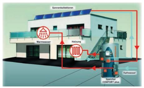
**Abb. 8.1** – Prinzipdarstellung der solaren Heizungsunterstützung: (1) Pumpstation Heizung, (2) Speicher, (3) Solarstation, (4) Frischwasserstation für das warme Brauchwasser; (Quelle: Sonnenkraft GmbH)
