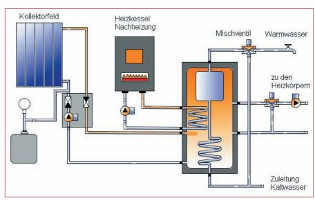
**Abb. 8.2** – Schema der solaren Heizungsunterstützung. Bei einem Speicher-im-Speicher-System dient der innere separate Speicher der Warmwasserversorgung, im Hauptspeicher wird die Wärme für die Heizkörper gespeichert; (Quelle: Darstellungen mithilfe des Programms Polysun-4, Institut für Solartechnik SPF)
