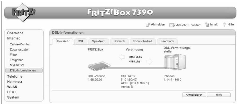
**Bild 1.7:** Die FRITZ!Box-Router von AVM zeigen die maximal verfügbaren Down- und Upload-Geschwindigkeiten an.
