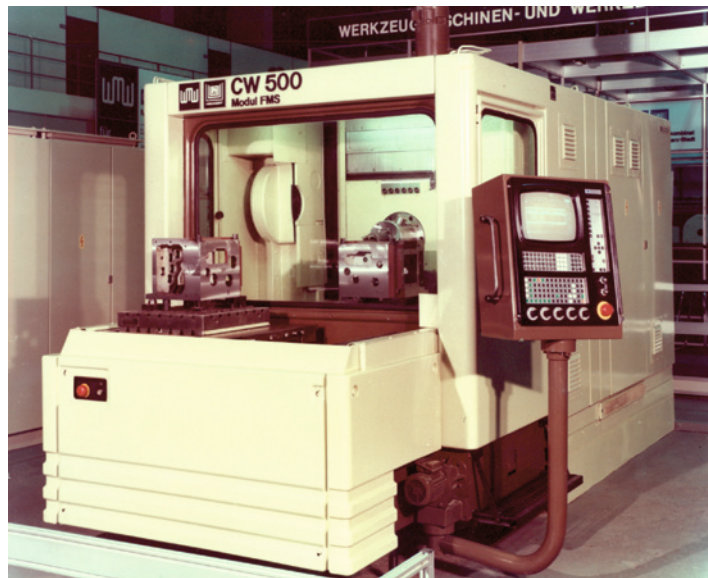
Bild 1.1: Die vom DDR-Steuerungshersteller VEB NUMERIK produzierte CNC-600 im Einsatz an einer Heckert-Maschine CW500, die auch als Modul für den FMS-Einsatz genutzt wurde.
