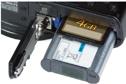
Speicherkarte und Akku teilen sich ein gemeinsames Fach an der Unterseite Ihrer RX100 III. (Foto: © digitalkamera.de)
