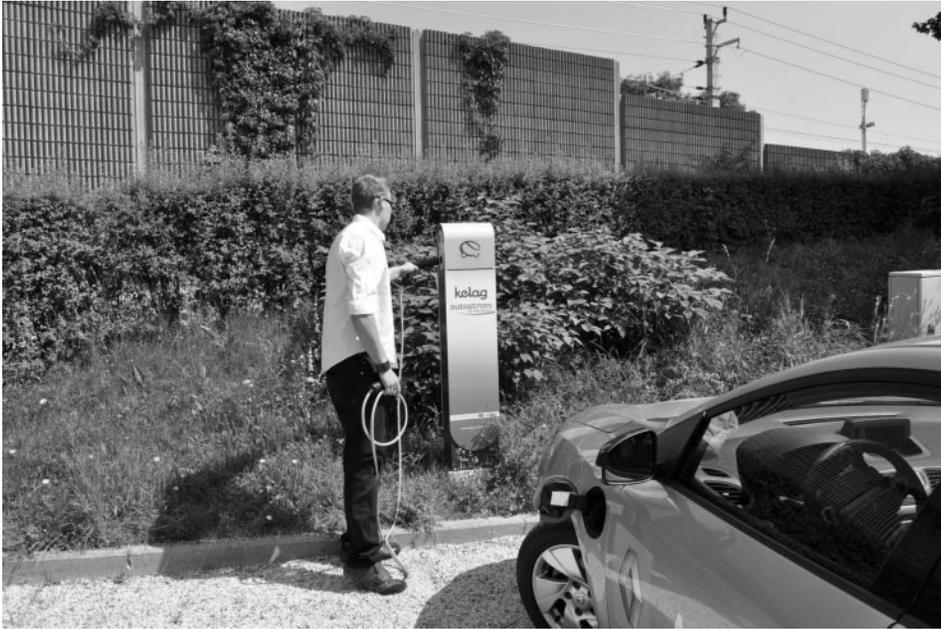
**Bild 5.6:** Das Ladekabel muss einfach zu handhaben sein, denn der Autofahrer will seine Fahrt fortsetzen und nicht das Laden »zelebrieren«. Die Kabel müssen deswegen so leicht und flexibel wie möglich sein. Foto: Gabi Schoblick/e-emotion.net
