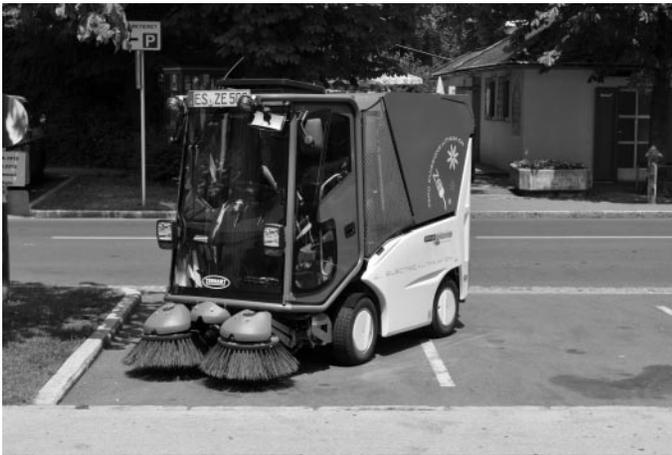
**Bild 1.7:** Dieses kleine Straßenreinigungsfahrzeug wird rein elektrisch angetrieben. Es eignet sich hervorragend für den Einsatz in Wohngebieten, wo es geräuscharm operieren kann. Foto: Gabi Schoblick/*e-emotion.net*
