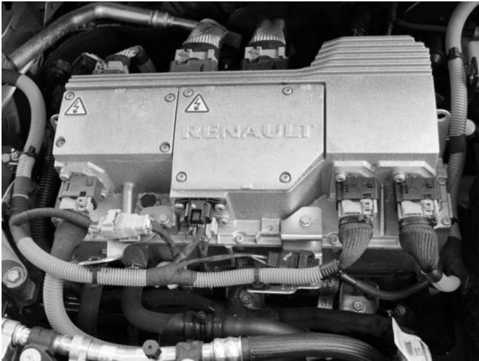
**Bild 7.3:** Deutlich zu erkennen sind die gelben Warnkennzeichen auf dem Motorblock des Elektroautos. Die markierten Abdeckungen dürfen auf keinem Fall von Laien entfernt werden. Die unter den Abdeckungen anliegenden Spannungen stellen eine Gefahr für das Leben dar! Foto: Gabi Schoblick/e-motion.net
