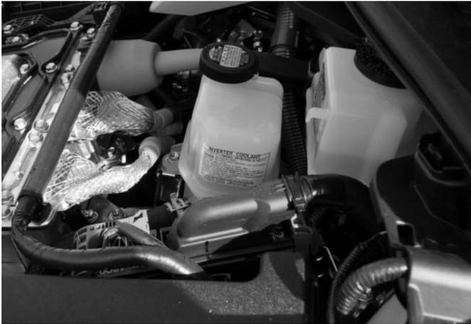
**Bild 7.2:** Ein Blick unter die Motorhaube des Prius-Hybrid macht das Fahrzeug deutlich als Elektroauto erkennbar, was dieser Wagen trotz des primären Verbrennungsantriebs im Sinne der Sicherheit bei Rettungs- und Bergungseinsätzen tatsächlich auch ist.
