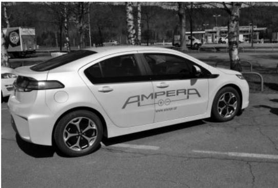
**Bild 1.13:** Der Opel Ampera ist ein Full-Hybridfahrzeug, das sowohl bis zu 80 km rein elektrisch als auch beliebig weit durch eigene Erzeugung elektrischer Energie mithilfe eines Verbrennungsmotors unterwegs sein kann.
