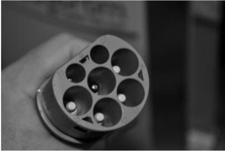
**Bild 5.1:** Der Typ-2-Stecker (benannt nach der Standardisierung in IEC 62196-2) ist der Standard für Ladekabel in weiten Teilen Europas, u. a. in Deutschland und Österreich. Weltweit kann man bei der IEC 62196 jedoch nur schwer von einer »Norm« sprechen, zumal in Japan und in den USA eigene Steckertypen favorisiert werden. Foto: Gabi Schoblick/emotion.net
