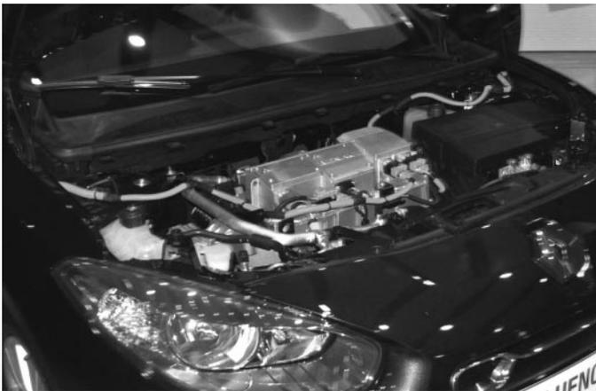
**Bild 5.4:** Die Hochvoltkabel in einem Elektroauto sind mit einer grell orangefarbenen Ummantelung optisch dominant. Die Signalfarbe ist ein Warnsignal für den Mechaniker zur Vermeidung von Unfällen. Foto: Gabi Schoblick/e-motion.net
