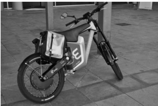
**Bild 1.3:** Pedale sind hier überflüssig, denn es handelt sich nur optisch um ein Fahrrad. Man fährt mit einem Elektroantrieb.
