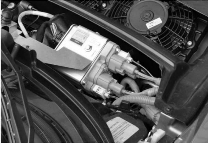
**Bild 5.5:** Die Anschlüsse der Hochvoltkabel, hier bei einem Tesla Roadster, sind nicht nur gesteckt, sondern zu deren Sicherheit auch noch verschraubt. Foto: Gabi Schoblick/e-motion.net
