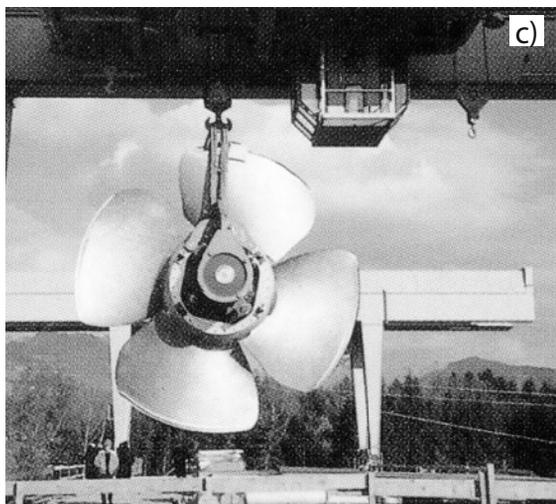
**Bild 4:** a) Die erste industrielle Kaplan-Turbine aus Velm, Niederösterreich, 1919; Die erste Kaplan-Großturbine und der Vergleich zu heute: b) Laufrad Lilla Edet (1925),  $P = 8,1$  MW,  $D = 5,8$  m; c) Oberaudorf-Ebbs (1992),  $P = 34,5$  MW,  $D = 6,1$  m
