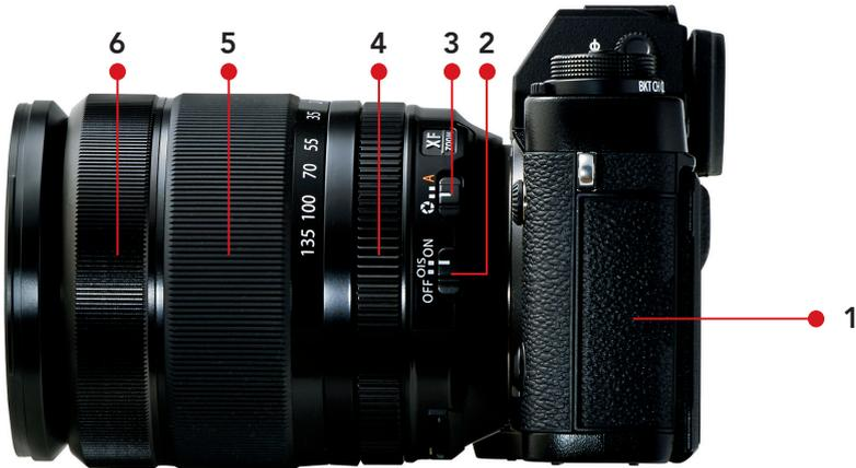
Abbildung 4: Linke Seitenansicht der X-T1 (mit XF18-135-mm-Zoomobjektiv): USB-/HDMI-Anschlussfachdeckel (1), Ein-/Aus-Schalter für OIS (Optical Image Stabilizer/optischer Bildstabilisator) (2), Blendenmoduswahlschalter (3), Blendenring (4), Zoomring (5), Fokusring (6)
