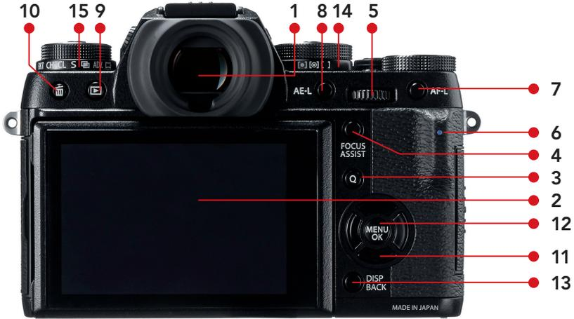
Abbildung 3: Rückansicht der X-T1: Elektronischer Sucher (1), ausklappbarer LCD-Bildschirm (2), Q-Taste (Quick-Menü) (3), Focus-Assist-Taste (4), hinteres Einstellrad »Daumenrad« (5), Statusleuchte (6), AF-L-Taste (7), AE-L-Taste (8), Wiedergabetaste (9), vier Richtungstasten (auch hintere Fn-Tasten) (11), MENU/OK-Taste (12), DISP/BACK-Taste (13), Belichtungsmessmodus-Einstellrad (14), DRIVE-Einstellrad (15)
