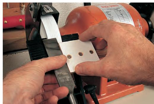
Mit dieser einfachen Vorrichtung wird der Stechbeitel im rechten Winkel gehalten, um ihn zu schleifen.
