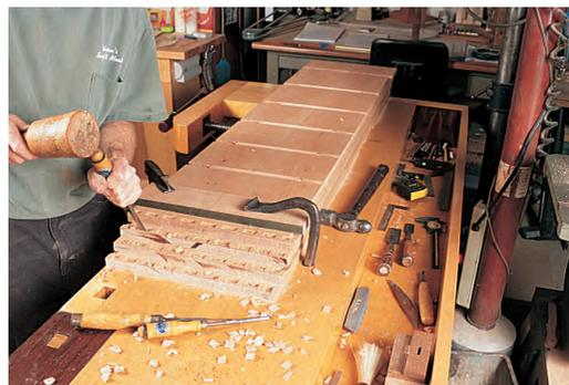
Ein Niederhalter wird in der Hobelbank verkeilt, um das Werkstück für Handarbeit – besonders mit dem Schnitzseisen oder Stechbeitel – zu fixieren.
