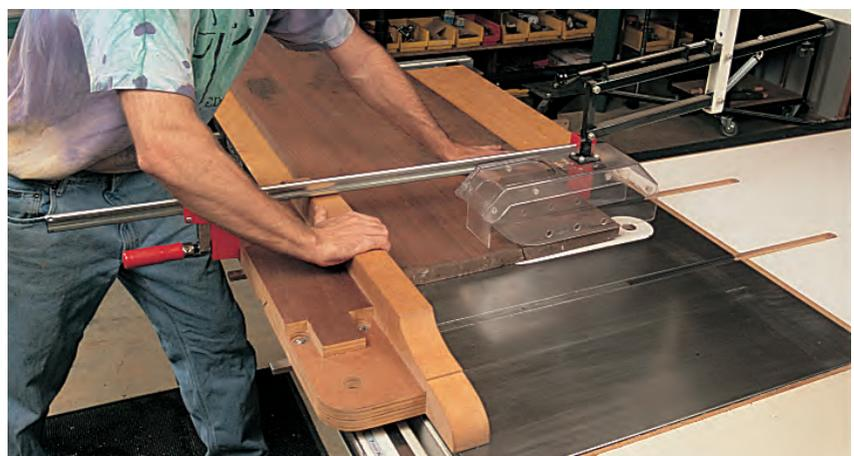
Die Tischkreissäge ist die wichtigste Maschine in jeder Tischlerwerkstatt. Man kann ihre Einsatzfähigkeit durch einen schweren Ablängschlitten erhöhen, der auch breite oder lange Bretter aufnehmen kann.
