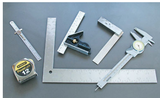
Von links nach rechts: Bandmaß, Stahllineal, großer Winkel, Kombiwinkel, kleiner Winkel und Schiebelehre mit Rundskala.
