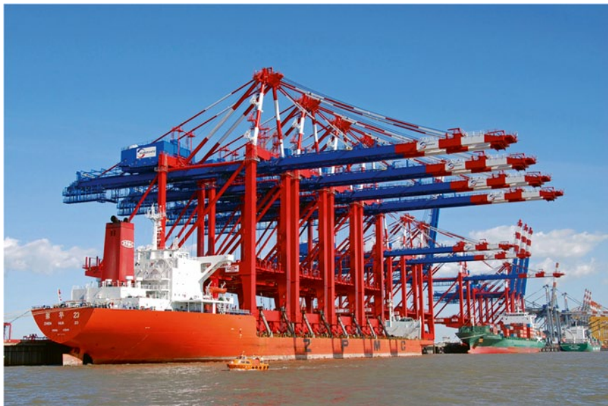
Abb. 1.1 ZPMC-Transportschiff mit montierten Krananlagen. (Quelle: Hans-Joachim Weiß, Bremerhaven)
