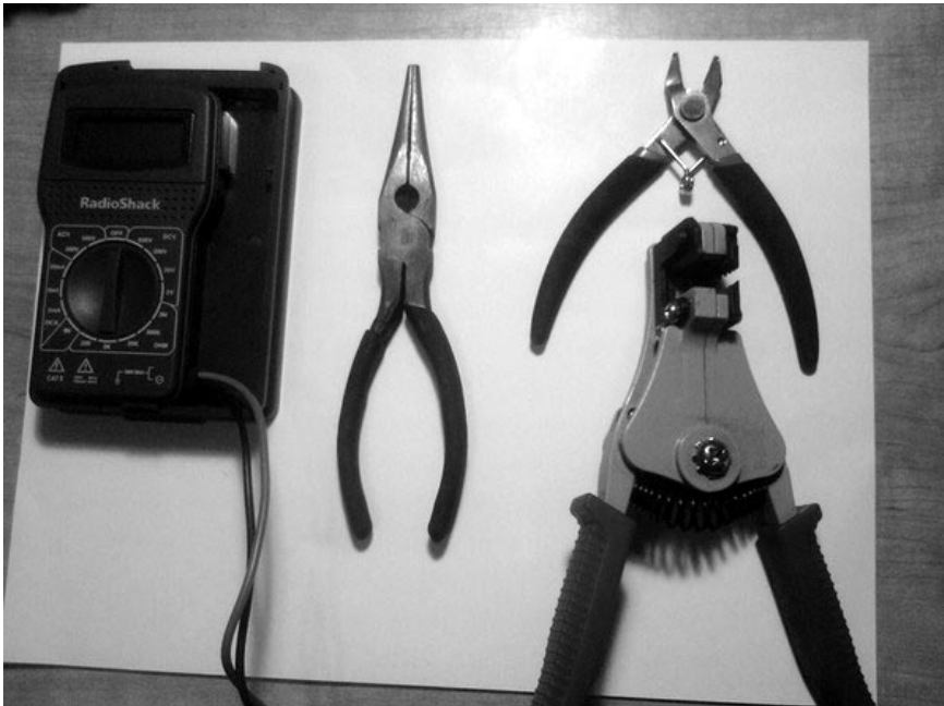
Bild 1.9: Wichtige Werkzeuge von links nach rechts: Multimeter, Spitzzange, Seitenschneider (oben), Abisolierzange (unten)
