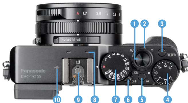
▲ Bedienelemente auf der Oberseite der LX100.
