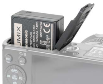
▲ In der LX100 werden Akkus vom Typ DMW-BLG10E (7,2 V, 1.025 mAh) verwendet.
