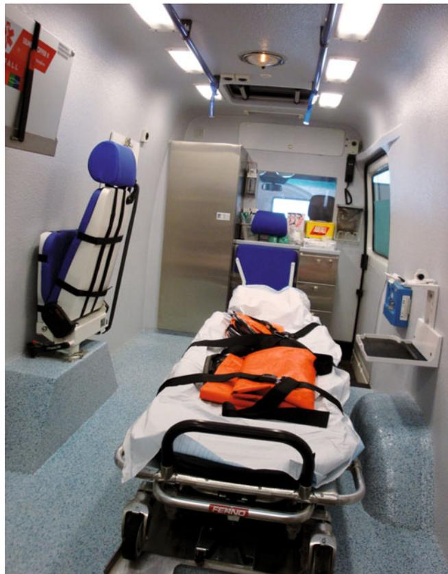
▣ **Abb. 1.6.** Infektionsfahrzeug auf Basis eines RTW von innen. Fast die gesamte Ausrüstung ist in Schränken verstaut. Dadurch ist die Desinfektion leichter durchführbar. (GR)
