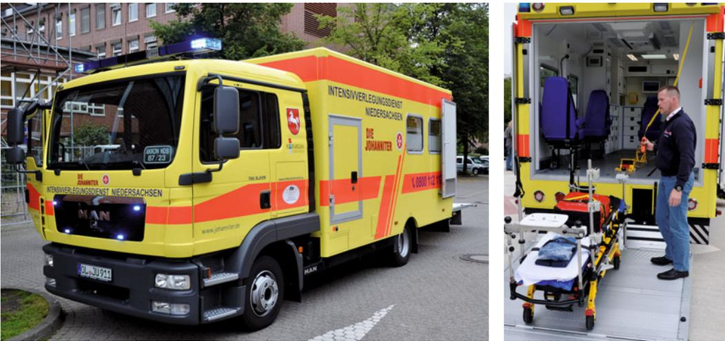
■ **Abb. 1.10a, b.** Intensivtransportwagen (ITW). **a** Das sehr innovative Fahrzeug ist auch für Schwerlasttransporte ausgelegt **b** Ansicht von hinten innen. Deutlich erkennbar: die Laderampe. (Foto: Zeitschrift RETTUNGSDIENST, [www.skverlag.de](http://www.skverlag.de)).
