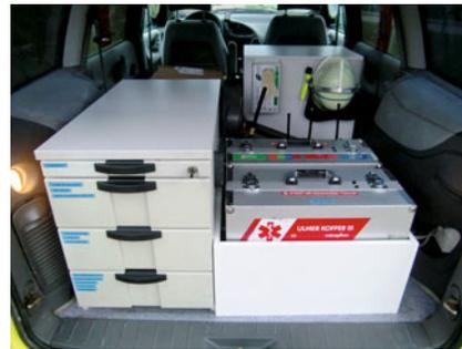
■ **Abb. 1.17a, b.** Fahrzeug des organisatorischen Leiter Rettungsdienst (OrgL). **a** Außenansicht. **b** Ansicht von hinten innen. Das Dokumentations- und Arbeitsmaterial ist in Schränken gelagert. Zusätzlich befindet sich eine Notfallausrüstung für den Firstresponder-Einsatz auf dem Fahrzeug. (BN)
