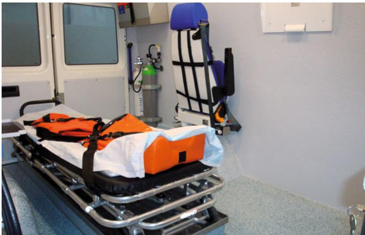
■ **Abb. 1.8.** RTW für schwergewichtige Patienten. In das Fahrzeug wurde eine Schwerlasttrage mit Überbreite eingebaut. (GR)
