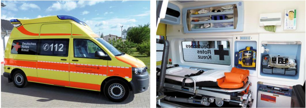
■ **Abb. 1.2a,b.** Krankentransportwagen (KTW): **a** KTW-Außenansicht. **b** KTW-Innenansicht. Das Fahrzeug ist nicht zum Transport von Notfallpatienten vorgesehen und verfügt daher über weniger Platz und Ausrüstung. (BN)
