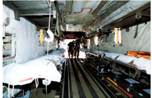
■ **Abb. 1.19a,b.** Großraum-Rettungshubschrauber (GR-RTH): **a** Bundeswehr-GR-RTH Sikorsky CH-53 mit mobilen Beladungsboxen. Neben Überwachungseinheiten, Beatmungsgeräten und zahlreichem Verbandsmaterial werden auch Vakuummatratzen mitgeführt. **b** Bundeswehr-GR-RTH-Innenansicht. An der Hubschrauberwand befinden sich 2 Tragen-galerien zu je 4 Tragen. (OV)
