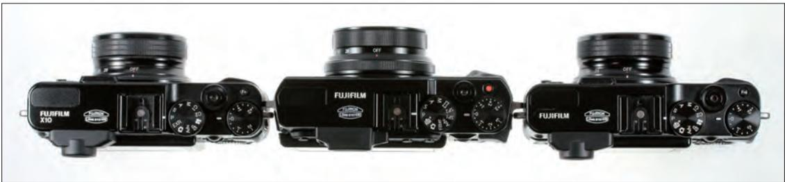
▲ Vergleicht man die Oberseiten der drei Kameras, fallen die Unterschiede etwas geringer aus – lediglich die Beschriftung des Programmwahrads hat sich etwas geändert, und die Belichtungskorrektur umfasst bei der X30 (Mitte) drei Blendenstufen.
