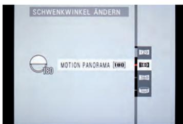
◀ Vier verschiedene Schwenkwinkel und vier Richtungen stehen bei der Panoramaaufnahme zur Verfügung: 120, 180, 360 und 360 Grad endlos. In der Einstellung 360 Grad endlos versucht die X30, Anfang und Ende zu einem endlosen Panorama zusammenzufügen. Das erfordert sehr sorgfältiges Arbeiten, sonst klappt's nicht.
