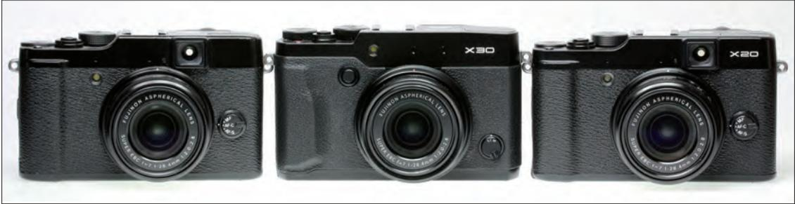
▲ Von vorn fällt ein Unterschied zwischen der X30 in der Mitte und den beiden Vorgängermodellen Fujifilm X10 (links) sowie X20 (rechts) auf: Die Linse des optischen Suchers fehlt. Der obere Bereich der Vorderfront ist neu gestylt und wirkt
