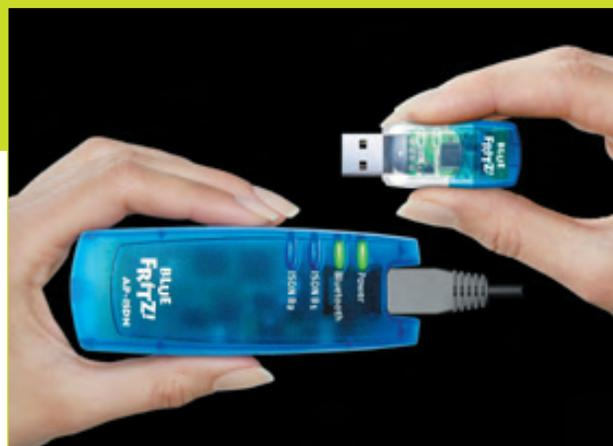
**Abb. 8.1** – So sehen die beiden Bluetooth-Komponenten für die drahtlose Anbindung eines Rechners an das ISDN-Netz aus. Hier der BlueFRITZ! AP-ISDN und der BlueFRITZ! USB von AVM Berlin
