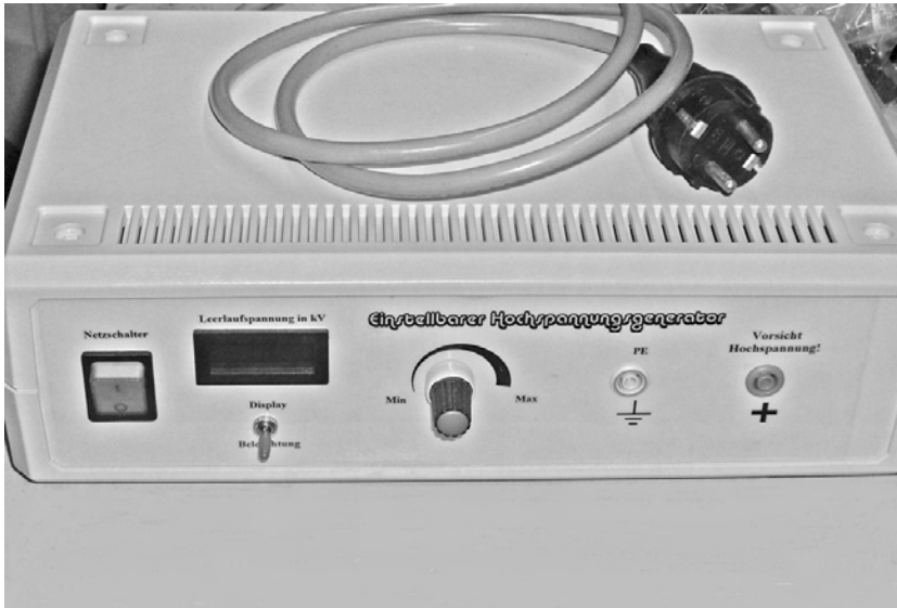
Abb. 2.21: Einstellbarer Hochspannungsgenerator mit 20-stufiger Villard-Kaskade
