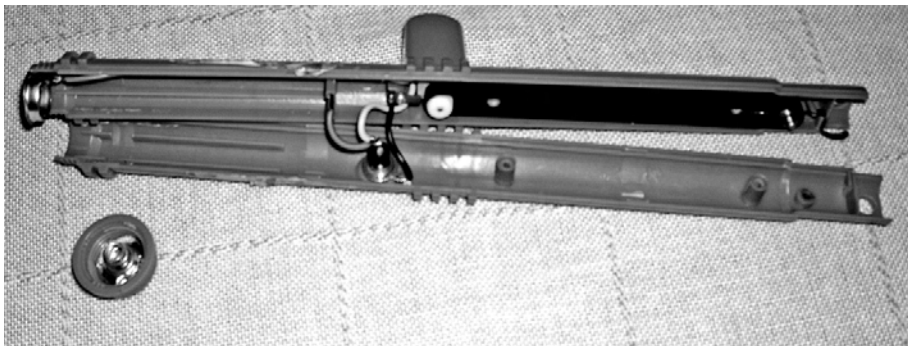
Abb. 2.18: Fun-Fly-Stick TM Magic Levitation Wand in geöffnetem Zustand; deutlich sind das Band und der Antriebsmotor zu sehen.
