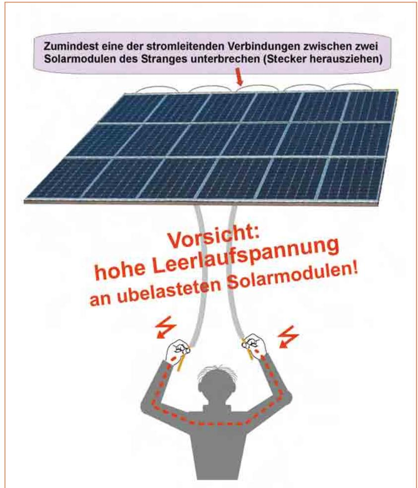
**Abb. 7.11** – Nicht vergessen: Vor jeder Arbeit an den spannungsleitenden Teilen einer Photovoltaikanlage sollte aus Sicherheitsgründen die Stromverbindung der Module unterbrochen werden.
