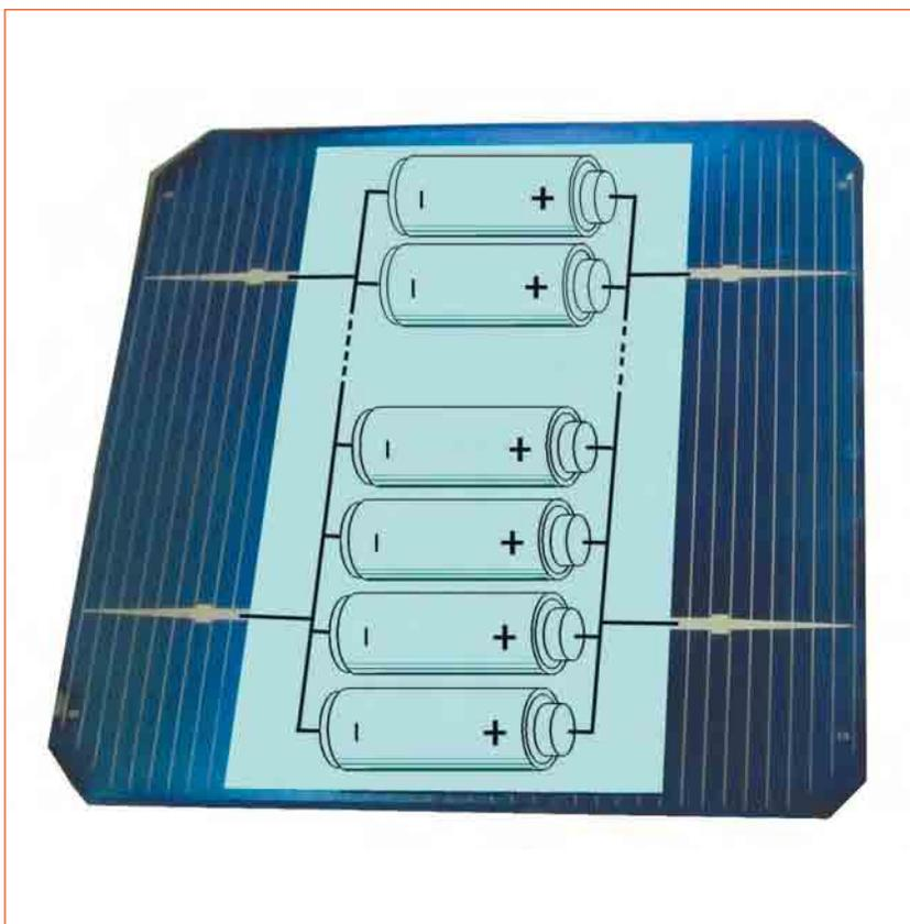
**Abb. 7.4** – Eine Solarzelle besteht aus einer großen Anzahl von „Mini-Spannungsquellen“, die vereinfacht mit einer größeren Menge parallel verschalteter Batterien verglichen werden können: Die Entnahme einiger Batterien hat keinen Einfluss auf die Ausgangsspannung, sondern nur auf den Strom, den die restlichen Batterien liefern können.
