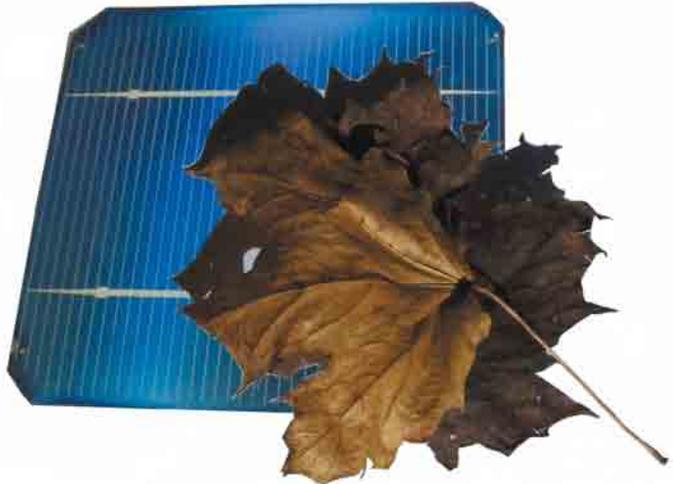
**Abb. 7.3** – Angewehtes Laub, Schmutz oder Schnee verkleinern ebenfalls die aktive Fläche der Solarzelle und verringern die Zellenleistung.
