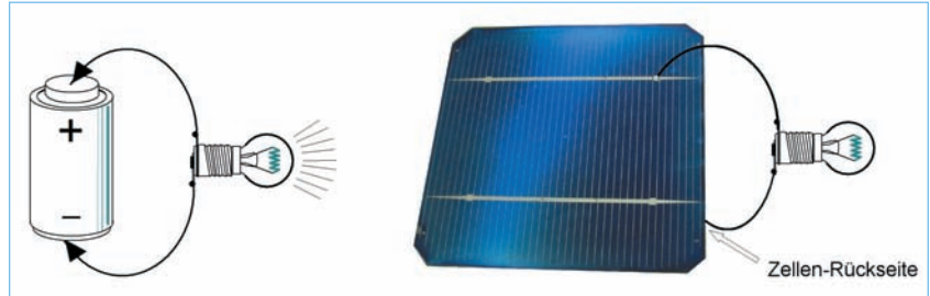
Abb. 2.4 – Eine Batterie kann durch eine Solarzelle ersetzt werden.
