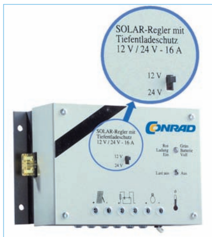
Abb. 8.2 – Ausführungsbeispiel eines Conrad-Solarladereglers, der wahlweise für das Laden von 12- und 24-Volt-Batterien mit einem Ladestrom von bis zu 16 A vorgesehen ist.
