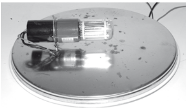
Abb. 5.12: Der Multiplier 1P28 auf dem Eimerdeckel
