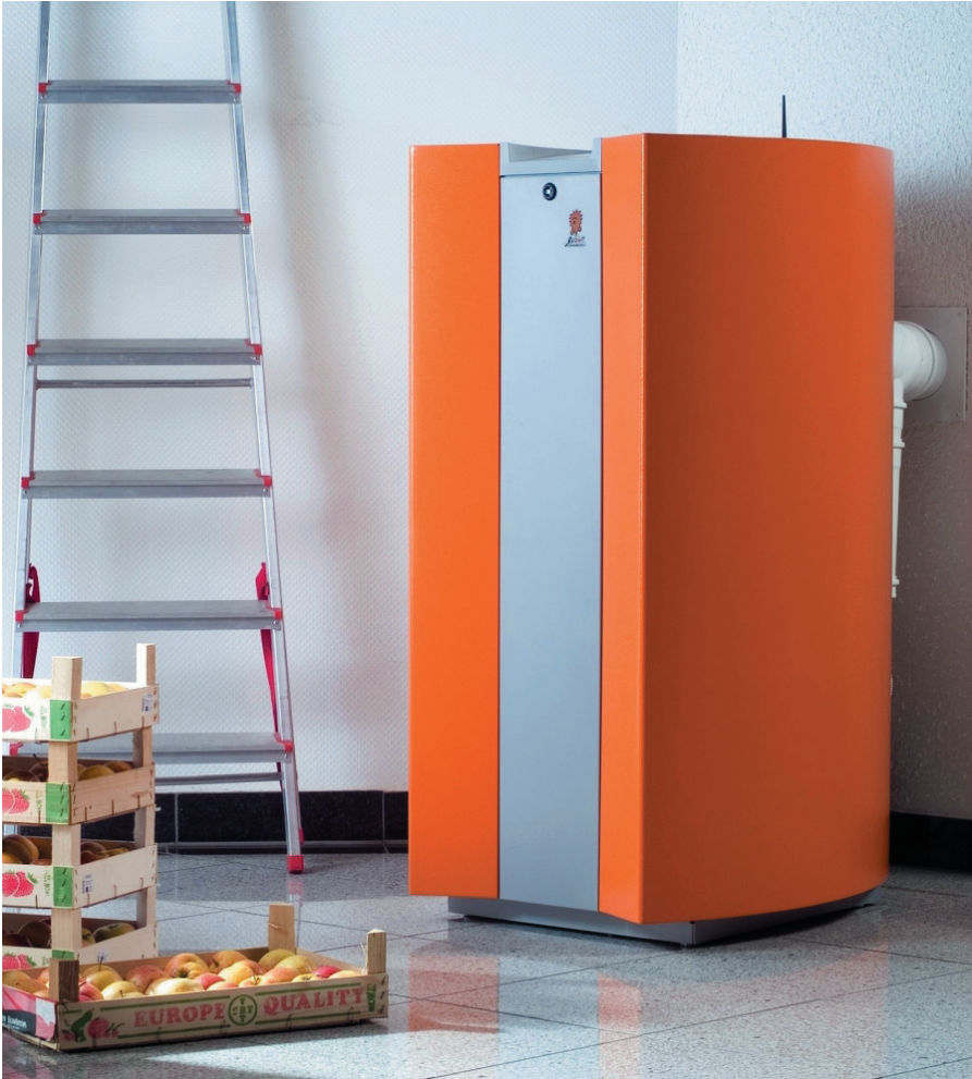
Abb. 4.5: Der Lion-Powerblock ist ein Mikro-BHKW, das die Dampfexpansion als Antrieb nutzt; Leistung: 0,3 bis 3 kW elektrisch und 3,5 bis 16 kW thermisch (Foto: Otag)
