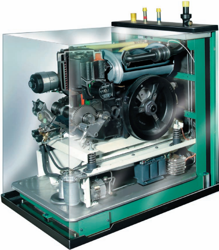
Abb. 4.3: Das Mini-BHKW „Dachs“ von SenerTec wird von einem Einzylindermotor angetrieben (oben), etwa in der Bildmitte ist der zylinderförmige Generator; Leistung mit Heizöl: 5,3 kW elektrisch und 10,5 kW thermisch. Es gibt auch Ausführungen, die mit Rapsöl, Erdgas oder Flüssiggas betrieben werden können. (Grafik: SenerTec)
