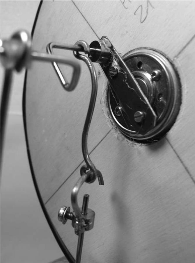
**Abb. 4.2:** Versuche mit speziellem Pleuel zur diskontinuierlichen Verdrängersteuerung
