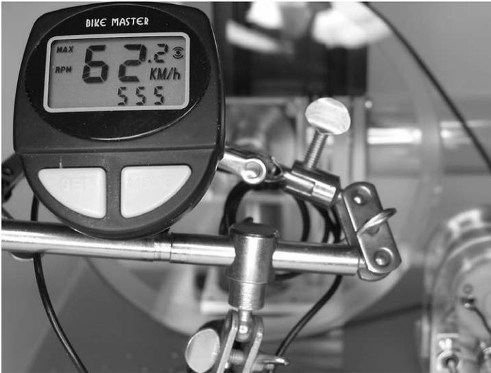
Abb. 5.1: Fahrradtacho mit Anzeige der Drehzahl rechts unten (RPM, 555)
