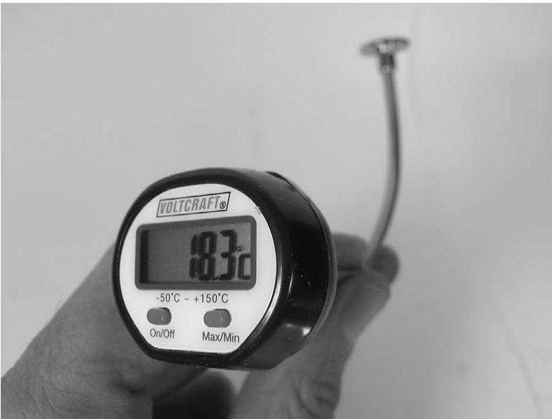
**Abb. 5.5:** Der Schaft eines Oberflächenthermometers wurde vorsichtig gebogen. Durch die Drahtumwicklung knickt das dünne Rohr beim Biegen nicht ab.
