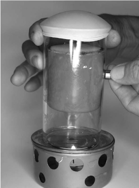
**Abb. 4.3:** Einfache Magnetsteuerung mit Hand, Arbeitskolben ist die Membran
