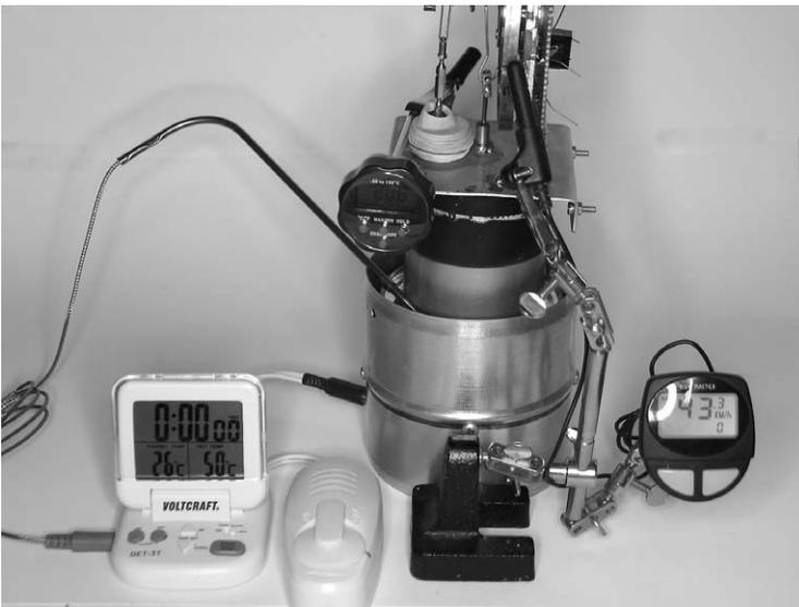
Abb. 5.8: Gleichzeitige Ermittlung von Temperatur und Drehzahl
