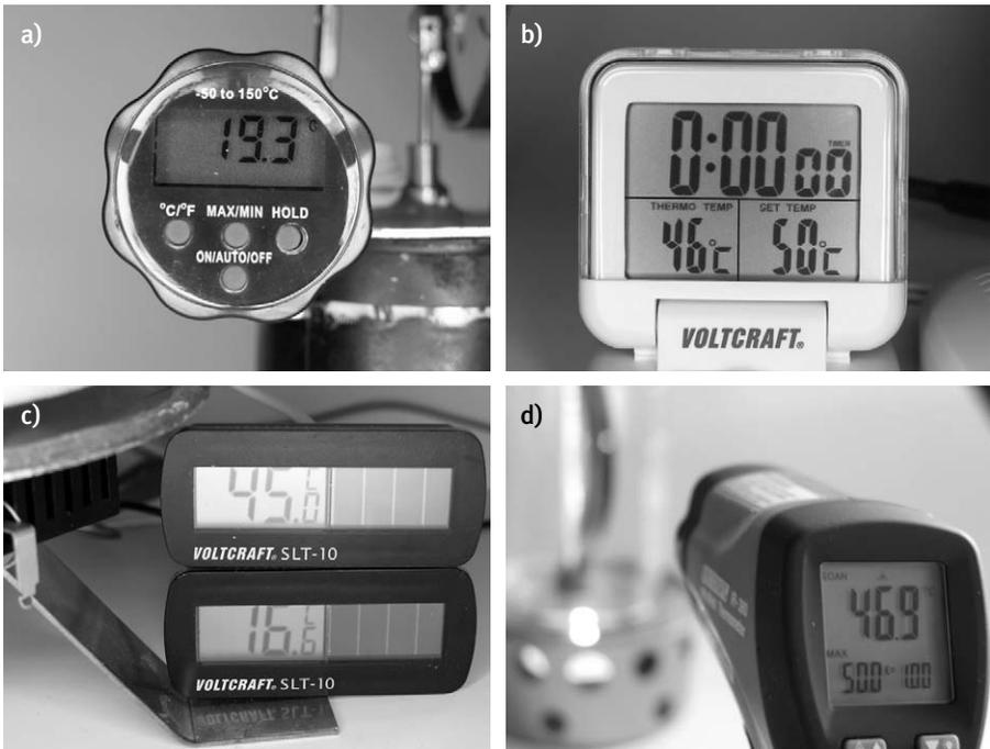
**Abb. 5.4:** Verschiedene Temperaturmessgeräte: a) Oberflächenthermometer, b) Thermometer mit einstellbarem Grenzwert und Messfühler, c) Oberflächenthermometer mit Solarstromversorgung, d) Infrarotthermometer mit Laserstahl zur punktgenauen Messung
