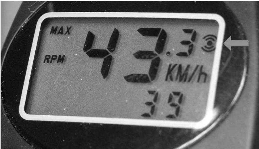
Abb. 5.2: Fahrradtacho in der Funktion; Drehzahlmesser – der rote Pfeil zeigt auf das Symbol der Impulsanzeige.
