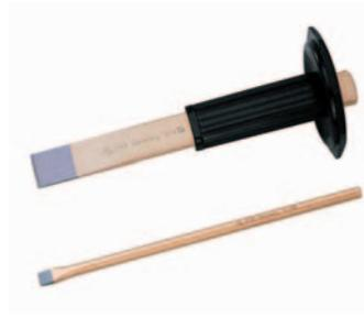
**Meißel** braucht man nur, wenn z. B. in die Wand gestemmt werden muss, um eine Unterputz-Gerätedose oder ein Leitungsrohr für das Antennenkabel zu verlegen. Für grobe Arbeiten eignet sich am besten ein Flachmeißel mit einem Gummischutz, der die Hand vor fehlgeleiteten Schlägen schützt (oben abgebildet). Für feinere Arbeiten ist ein feiner Flachmeißel mit einer Klingenbreite von ca. 8 bis 10
