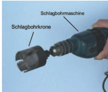
Sie wird – ähnlich wie ein Bohrer – in eine Schlagbohrmaschine eingesetzt und fräst die erforderlichen Löcher für Unterputzdosen (von ca. Ø 65 mm) relativ schnell und bequem aus. Allerdings um den Preis, dass dabei eine kräftige Staubentwicklung entsteht, die eigentlich nur in einem Rohbau oder bei aufwändigen Renovierungsarbeiten in Kauf genommen werden dürfte. Andernfalls sollte auf die Anwendung einer Schlagbohrkrone verzichtet werden (siehe hierzu auch das Thema „Unterputzdosen
