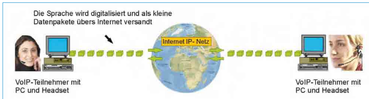
Abb. 1.2 – Die Internettelefonie von PC zu PC mit einer Telefonsoftware ist der für Neueinsteiger geeignetste und einfachste Weg, VoIP kennenzulernen.
