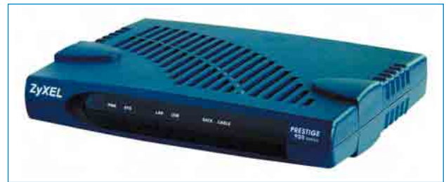
Abb. 1.6 – Das Kabelmodem ZyXEL P-964M (Quelle: www.ZyXEL.de ).
