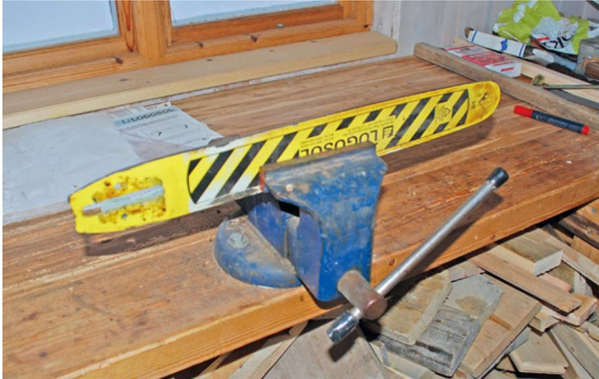
Spannen Sie die Schiene in einen Schraubstock ein. Wenn die Laufflächen soweit herunter gefeilt sind, dass die Treibglieder auf dem Boden der Nut laufen, hat die Schiene ausgedient. Die Sägekette wird dann schräg sägen und man kann eine leichte Abnutzung an der untersten Spitze der Treibglieder erkennen.
