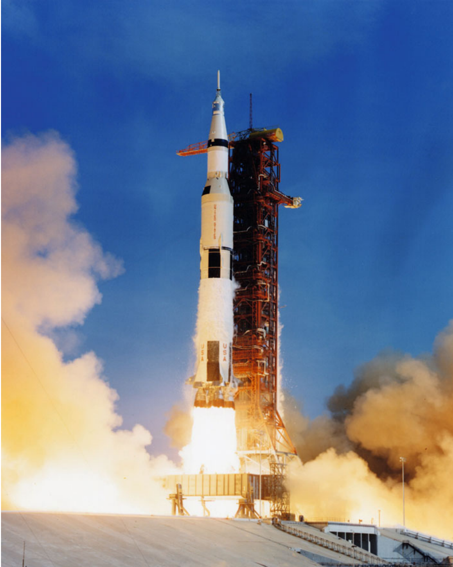
Abb. 1: Die Saturn-V-Mondrakete mit Apollo 11 auf dem Weg zum Mond. Diese leistungsstärkste Maschine, die je gebaut wurde, wog mit ihren fast 111 Metern Höhe knapp 3000 Tonnen und entwickelte einen Schub von fast 3500 Tonnen, also etwa 160 Millionen PS. Foto: NASA. Nr.: AP11-KSC-69PC-442.
