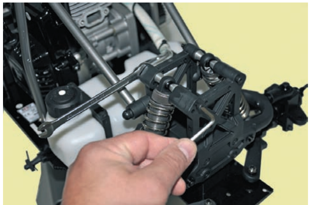
Bild 15.4 – Durch Lösen der oberen Schrauben werden die Stoßdämpfer von der Dämpferbrücke ausgebaut.
