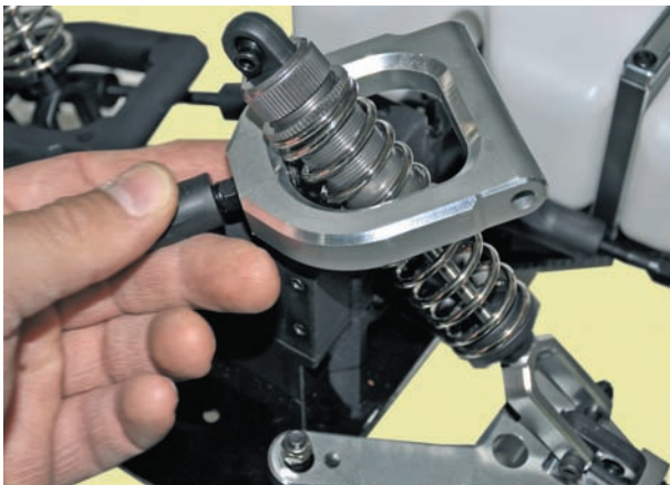
Bild 15.14 – Der Stoßdämpfer wird durch den oberen Aluminium-Querlenker gefädelt.
