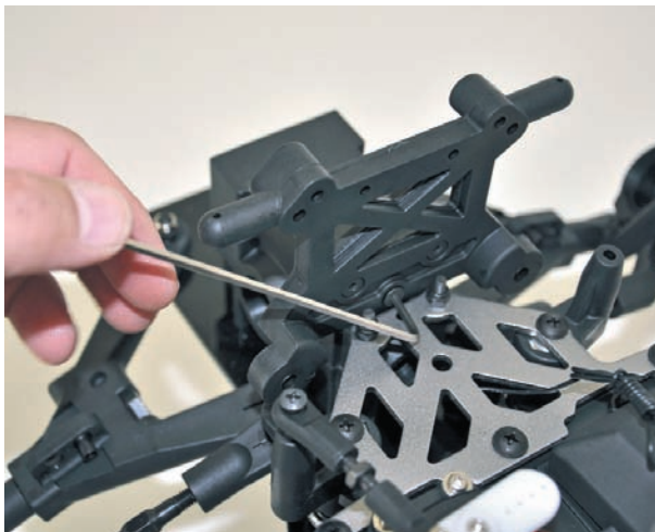
Bild 14.10 – Um beim Ausbau der unteren Querlenker noch mehr Platz zu gewinnen, entfernen wir auch den hinteren Teil der Dämpferbrücke. Sie wird ohnehin gegen eine neue aus Aluminium ausgetauscht.
