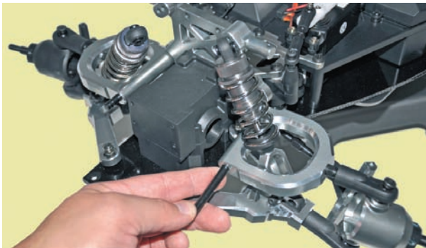
Bild 14.22 – Anschließend sind die langen Querlenkerstangen durch die Bohrungen der oberen Querlenker und anschließend durch die dafür vorgesehene Bohrung an der rückwärtigen Dämpferbrücke zu stecken.
