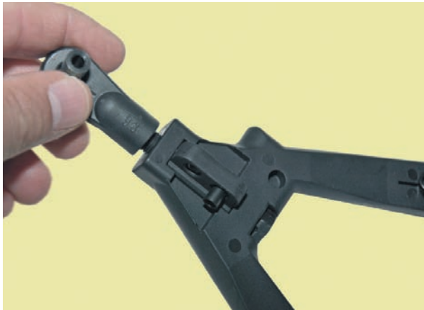
Bild 15.10 – Nachdem die unteren Querlenker von der Bodenplatte abgeschraubt wurden, ist von ihrer Spitze zuerst der Kugelgelenkhalter zu entfernen.
