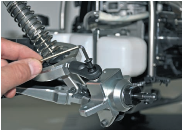
Bild 15.15 – Er wird anschließend am Achsschenkelhalter angeschraubt.
