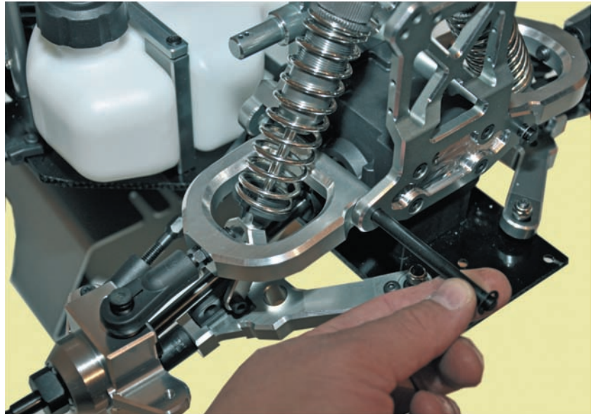
Bild 15.18 – Der obere Querlenker ist mit einem Querlenkerstift an der Dämpferbrücke zu montieren.
