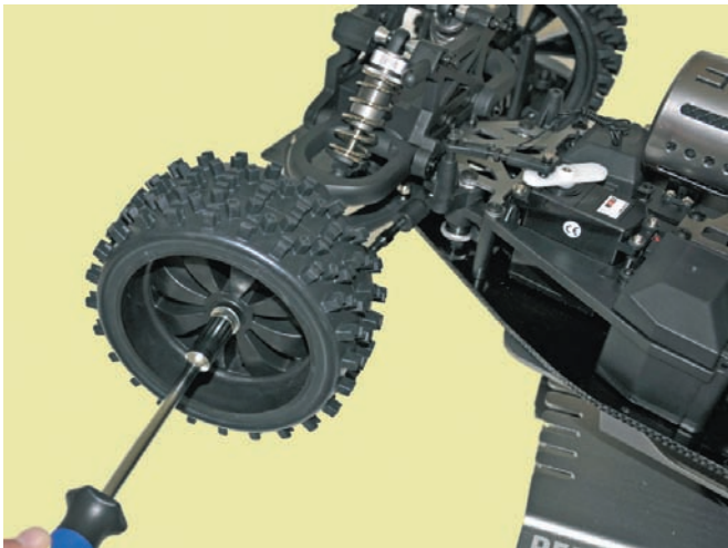
Bild 14.4 – Zuerst lösen wir die beiden Vorderräder.
