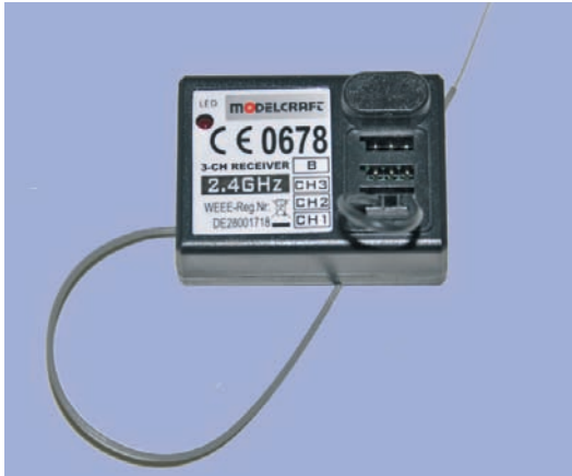
Bild 1.11 – 2,4-GHz-Empfänger benötigen keinen Empfängerquarz, der auf einer bestimmten Frequenz arbeitet. Bei diesen Systemen sind Sender und Empfänger aufeinander angelernet. Weiterer Vorteil: die kurze Antenne.
