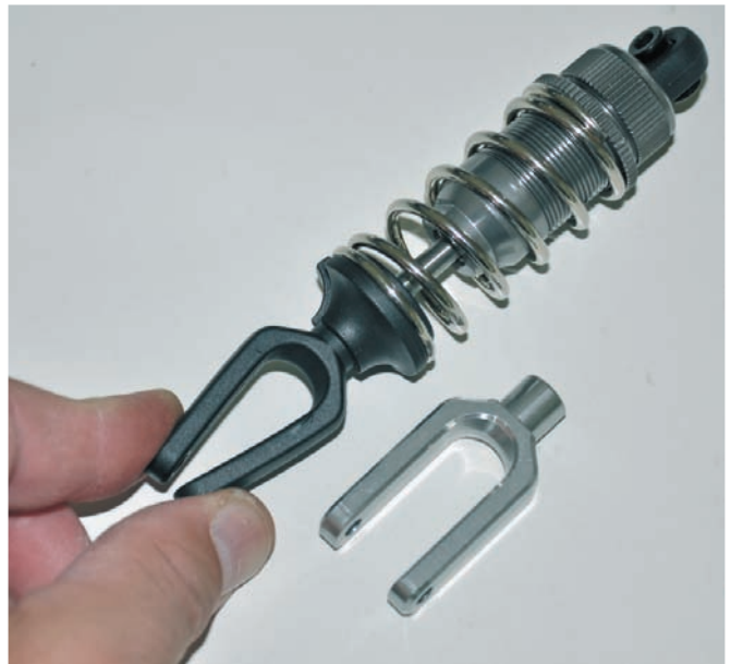
Bild 14.15 – Die im Auslieferungszustand des Carbon Fighters eingebauten Stoßdämpfergabeln lassen sich mit den Fingern zusammendrücken.
