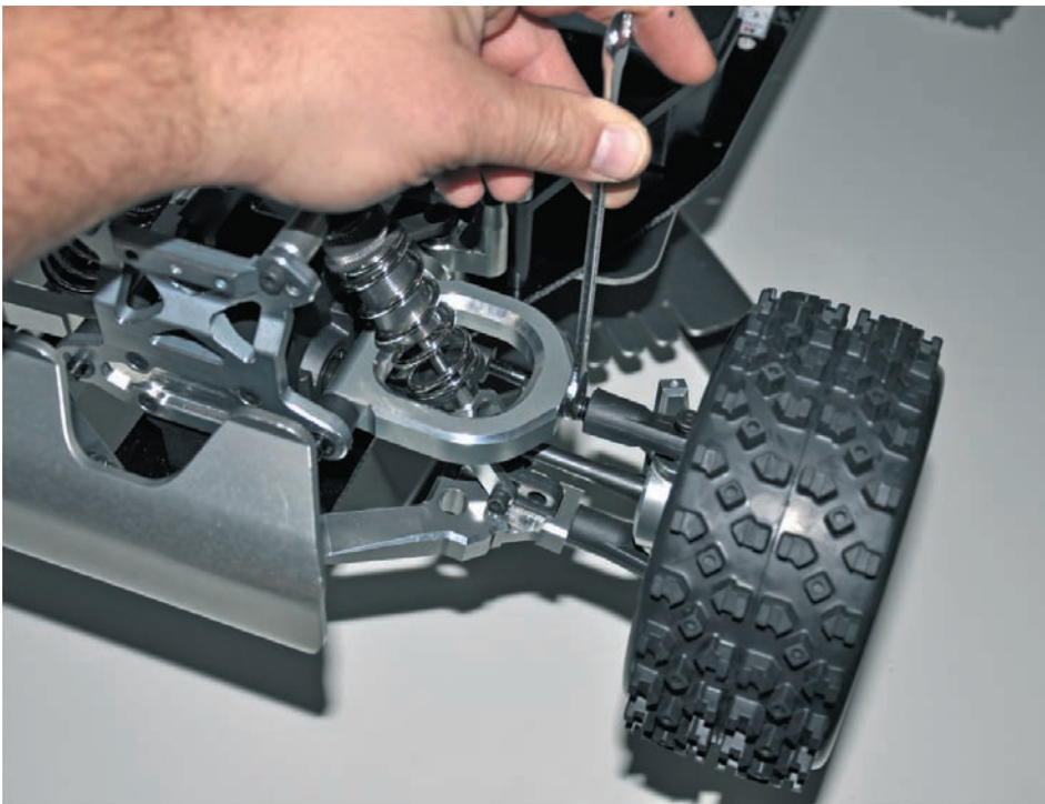
Bild 10.5 – Dreht man sie entgegen dem Uhrzeigersinn, vergrößert sich der Abstand der Radoberkante zum Chassis.
