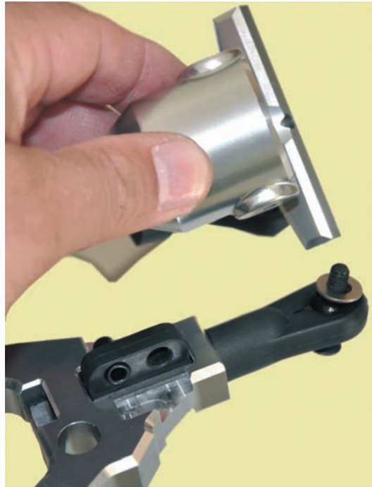
Bild 14.18 – Im zweiten Arbeitsschritt sind die Achsschenkel an den unteren Querlenkern zu befestigen.
