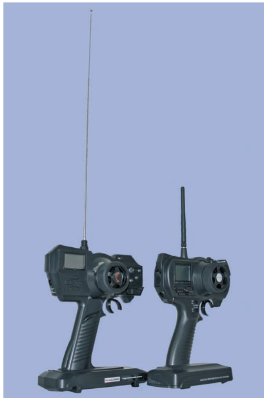
Bild 1.10 – 40-MHz-Fernsteueranlagen haben eine rund 80 cm lange Antenne. Moderne 2,4-GHz-Systeme benötigen indes nur eine kleine 9-cm-Antenne.
