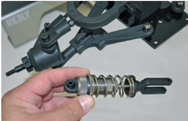
Bild 14.8 – Ausgebauter Stoßdämpfer im Detail
