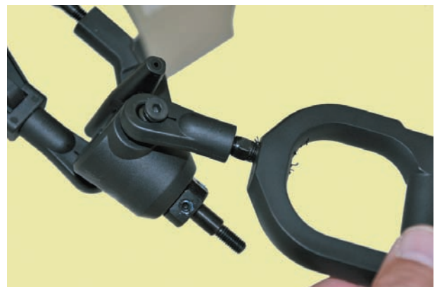
Bild 14.11 – Der obere Querlenker ist mittels Spannschraube mit dem Achsschenkel verbunden. So lässt er sich besonders leicht abschrauben.
