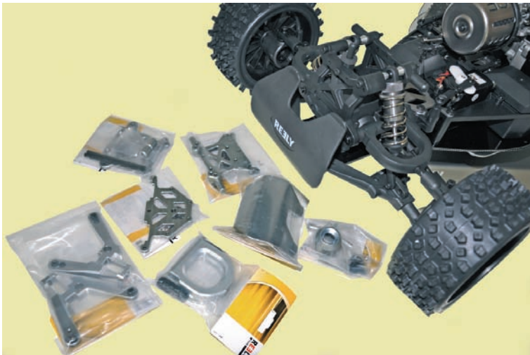
Bild 14.2 – Besonders für den vorderen Bereich gibt es für unser Modell viele Tuning-Teile. Da sie alle auf irgendeine Weise zusammengehören, bietet sich an, sie in einem Zug zu tauschen.
