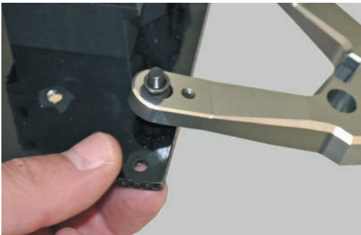
Bild 14.17 – Zuerst sind die unteren Querlenker an der Grundplatte zu montieren.
