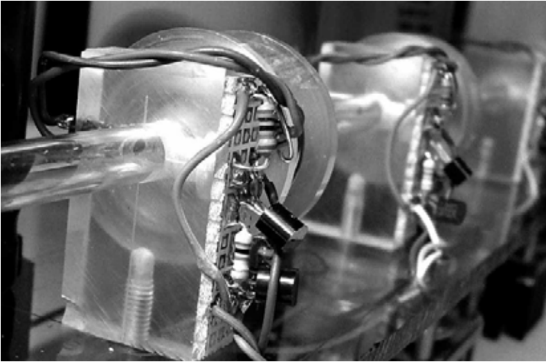
Abb. 43: Aufbau der Lichtschranke
