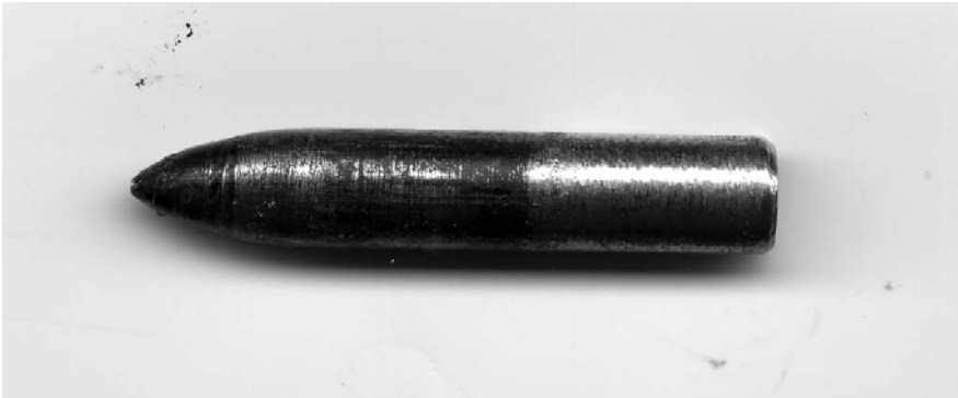
Abb. 38: Das teilweise isolierte Geschoss
