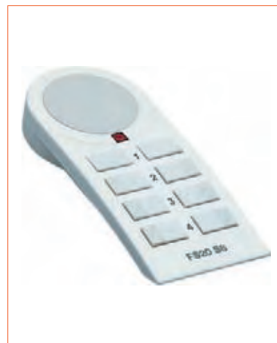
Abb. 2.3 – Den Handsender, eine Art Fernbedienung, kann man wahlweise im Vier- oder Acht-Kanal-Modus betreiben. Der Vier-Kanal-Betrieb ist übersichtlicher und damit einfacher zu bedienen.
