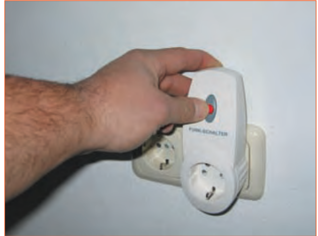
Abb. 2.1 – Hält man diese Taste mindestens 15 Sekunden gedrückt, gelangt die Funksteckdose in den Programmiermodus.
