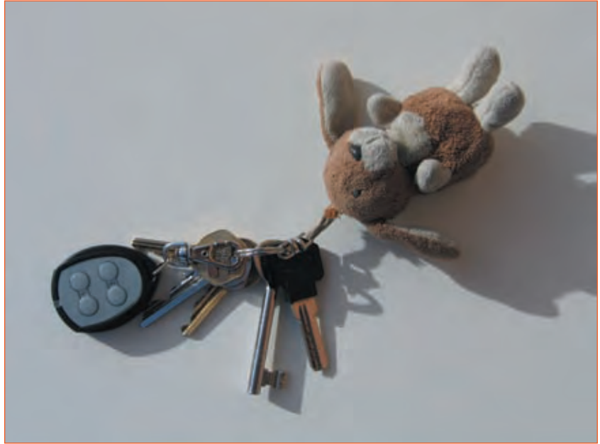
Abb. 2.6 – Den Mini-Handsender hat man als Schlüsselanhänger immer dabei. Er eignet sich so für Anwendungen außer Haus. Er steuert beispielsweise Garagentore oder kann als Hauptschalter alle Stand-by-Geräte vom Stromnetz trennen.
