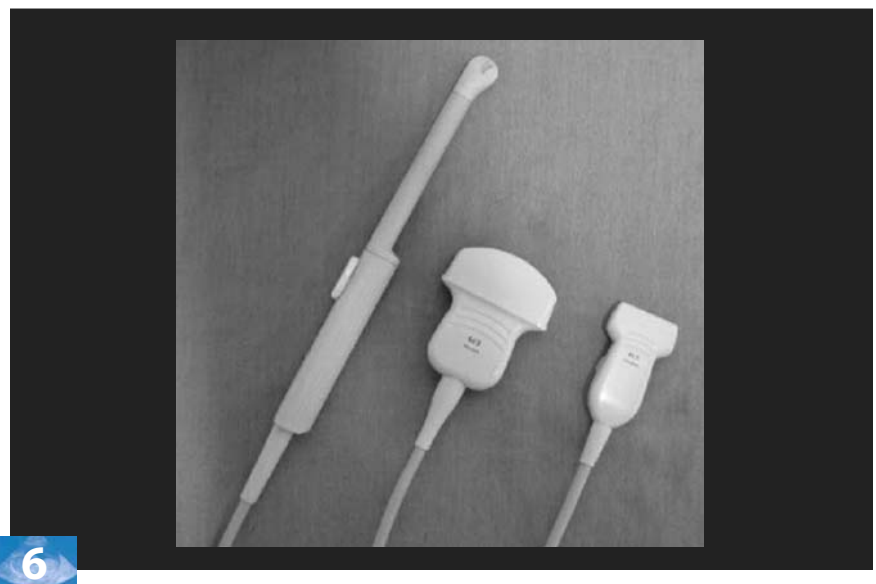
■ Abb. 1.6. Darstellung der Schallköpfe: Vaginalsonde 7 MHz zur gynäkologischen Sonographie, Curved-array-Schallkopf mit 5 MHz zur geburtshilflichen Sonographie und Linearschall- kopf mit 15 MHz zur Mamma- sonographie
