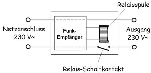
Neben netzbetriebenen Funk-Fernschaltern gibt es auch mit Gleichspannung betriebene Fernschalter. Sie verfügen meist über Umschaltkontakte, die als „potentialfrei“ ausgeführt sind, schalten somit keine Spannung „durch“, sondern stehen einfach zur Verfügung für beliebige Anschlüsse. Manche dieser Fernschalter sind mit mehreren Fernschaltkanälen ausgelegt, von denen jeder sein eigenes Relais und seinen eigenen Umschaltkontakt bedient.
