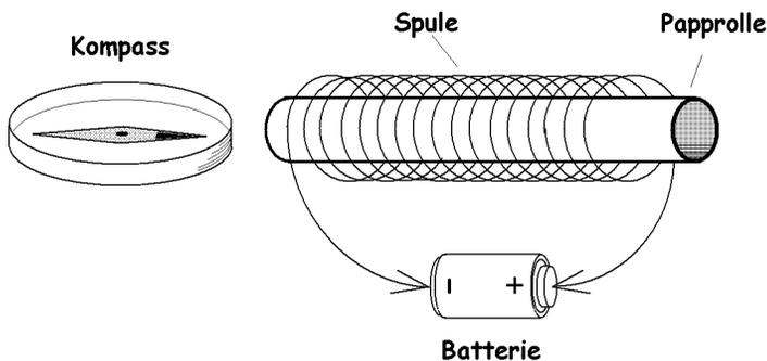
Ein elektromagnetisches Feld entsteht jedoch nicht nur um einen Elektromagneten, sondern um jeden elektrischen Leiter (Draht), durch den elektrischer Strom fließt. Auch dieses elektromagnetische Feld nimmt mit wachsender Entfernung von dem Leiter an Stärke ab.
