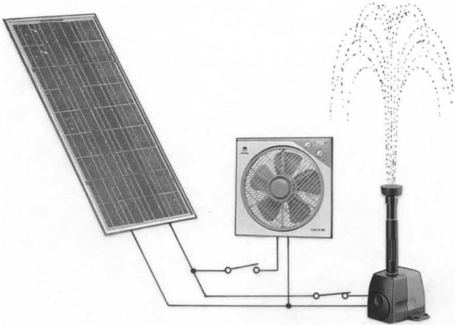
wird dann etwas langsamer drehen, der Pumpenmotor wird bei niedrigerer Solarspannung etwas weniger Wasser pro Minute pumpen, aber die Pumpe könnte dennoch laufen.
