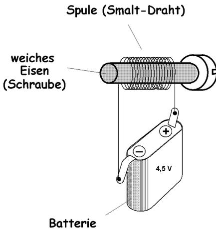
Das Prinzip eines einfachen Selbstbau-Elektromagneten zeigt die nebenstehende Lösung: Man nehme z.B. eine eiserne Schraube, wickelt um sie eine Art Spule aus dünnem Kupferdraht (Smalt-Draht), schließt diese Spule an eine Batterie an und ein Elektromagnet ist fertig. Ein solcher Elektromagnet verhält sich ähnlich wie ein Dauermagnet. Allerdings mit dem Unterschied, dass der Elektromagnet nur so lange eine magnetische Kraft besitzt, wie seine Spule an eine *Versorgungsspannung* angeschlossen ist.
