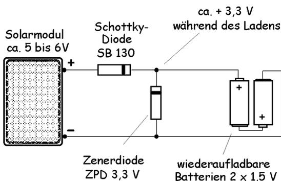
Mit der Anpassung der Solarmodulen-Nennspannung auf den exakten Ladebedarf klappt es nicht immer zufrieden stellend. Eine Abhilfe bietet eine Selbstbau-Laderegulierung mit einer Zenerdiode (Näheres über die Funktionsweise der Zenerdioden finden Sie im Kapitel 13).
