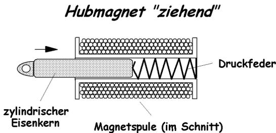
Das Interessante an der eigentlichen Funktionsweise eines *Hubmagneten* ist, dass die Magnetspule einen magnetisch leitenden (gleitenden) Kern in sich hineinzieht, wenn sie an eine Spannung angeschlossen wird. Sie
