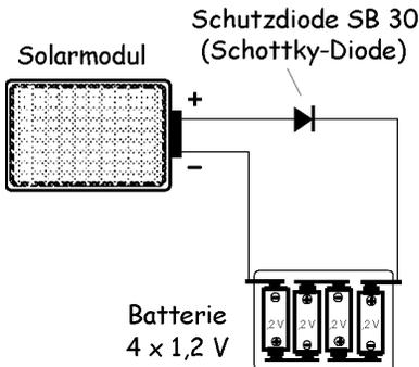
Kleinere NiCd- oder NiMH-Akkus können auch *ohne* einen zusätzlichen Laderegler direkt von einem Solarmodul geladen werden, wenn seine offizielle Nennspannung unterhalb der zulässigen Ladespannung der angewendeten Akkus liegt (bzw. maximal etwa um 20 % höher ist als die Akkuspannung). Der Ladestrom (= der Nennstrom des Solarmoduls) darf bei NiCd-Akkus 10 % der Akkukapazität, bei NiMH-Akkus 20 % der Akkukapazität nicht überschreiten.
