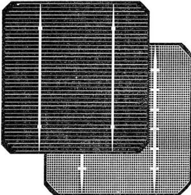
strom liegt bei etwa **2,9 A** bis **3,29 A** (typen- bzw. markenabhängig). In letzter Zeit mehren sich jedoch Angebote an größeren Solarzellen. Die momentan größten Abmessungen liegen bei ca.  $150 \times 150$  mm. Solche Zellen können dann einen Nennstrom von über **5 A** liefern. Die nebenstehende Abbildung (auf Seite 70) zeigt links die Vorderseite („Sonnenseite“) und rechts die Rückseite („Schattenseite“) einer „kahlen“ Solarzelle.
