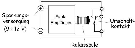
Netz-Funkschalter sind meist wesentlich preiswerter als Gleichspannungs-Funkschalter und können bei Bedarf für netzunabhängiges Schalten einfach dadurch umfunktioniert werden, dass man an sie ein externes Relais anschließt, dessen Magnetspule für 230 V~ ausgelegt ist.
