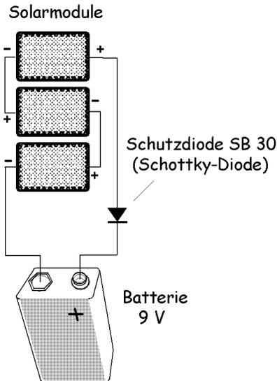
Für das Laden von kleineren wieder aufladbaren Akkus können auch z.B. mehrere kleine „gekapselte Solarmodule“ in Reihe geschaltet werden, um eine ausreichend hohe Ladespannung (Akkuspannung  $\times$  1,2) liefern zu können. Ihre einzelnen Spannungen addieren sich bei einer Reihenschaltung ähnlich wie die Spannungen von Batterien. Bei einem 9-V-Akku dürfte die Ausgangs-Nennspannung der drei eingezeichneten Module höchstens 10,2 Volt ( $9\text{ V} \times 1,2 = 10,2\text{ V}$ ) betragen.
