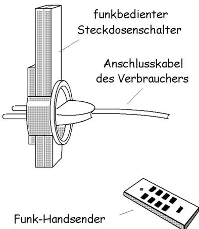
Das Funktionsprinzip eines Steckdosenschalters oder Lichtschalters ist einfach: Der Handsender „aktiviert“ mittels einer kodierten Funkfrequenz den Steckdosenschalter- oder Lichtschalter-Empfänger, in dem ein Schaltrelais den elektrischen Strom ein- oder ausschaltet.
