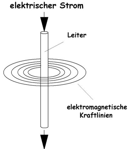
Wird ein Leiter (z.B. 4-mm<sup>2</sup>-Kupferdraht) zu einer Schleife geformt und über einen Verbraucher (Lämpchen) an eine Spannungsquelle angeschlossen, reagiert auch hier die Kompassnadel auf das elektromagnetische Feld der Schleife. Das Lämpchen fungiert hier nur als eine „Strombegrenzung“, die die Batterie schützt (andernfalls würde ein direkter Anschluss der Schleife an die Batterie einen Kurzschluss zufolge haben).
