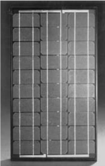
Solarzellen lassen sich mit Diamantsägen oder mit Laserstrahlen in beliebig kleine Stücke schneiden. Das ist für einen kleineren Leistungsbedarf sehr nützlich. Kleinere Solarmodule können – wie abgebildet – z.B. mit halben Zellen bestückt werden. Auf die Zellenspannung hat die Zellenteilung praktisch keinen Einfluss.
