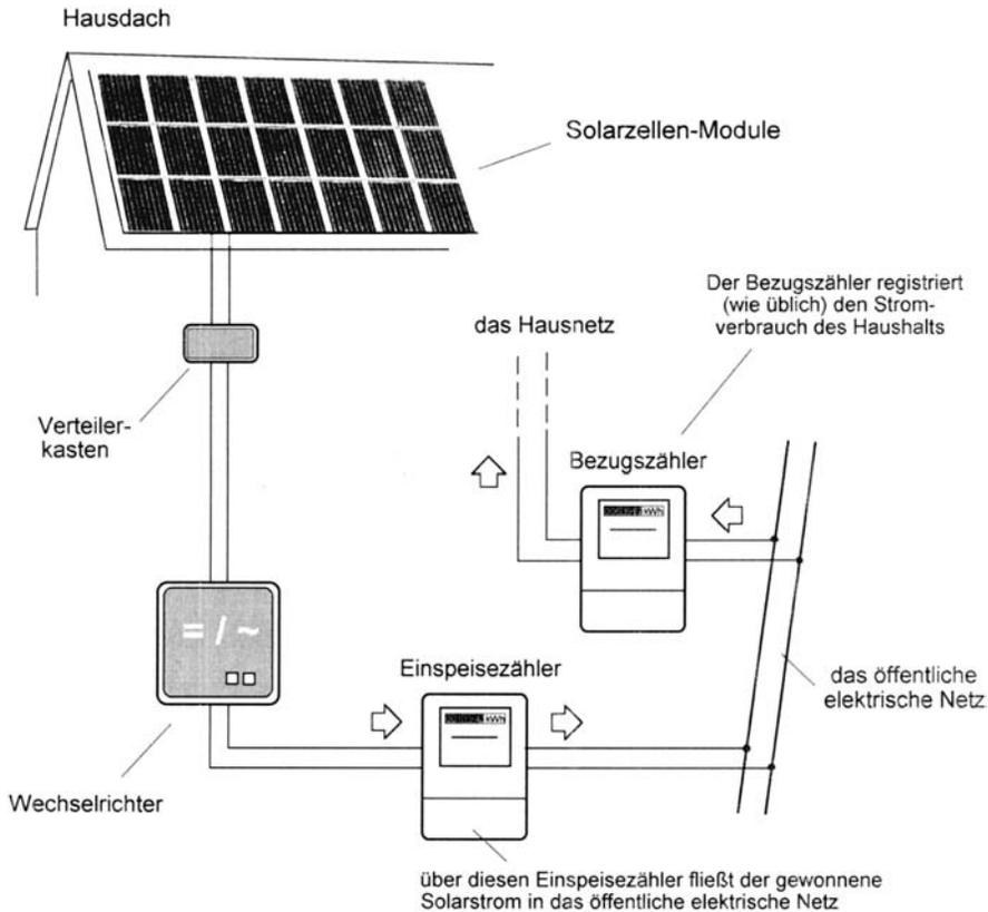
Bei netzgekoppelten Fotovoltaik-Anlagen wird die gewonnene Solarenergie nicht zwischengespeichert, sondern über einen (hauseigenen) Wechselrichter in das öffentliche Netz eingespeist. Hier muss jedoch der Wechselrichter auf die Leistung und Spannung der ganzen Solarzellen-Fläche optimal abgestimmt werden.
