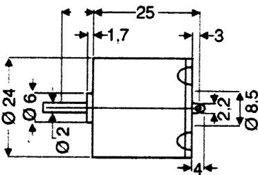
Einige spezielle Solar-Kleinmotoren geben sich mit einer Betriebsspannung zufrieden, die bei ca. 0,5 Volt liegt. So kann z.B. eine kleine Drehbühne oder ein kleines Solarspielzeug den Energiebedarf aus einer einzigen Solarzelle beziehen.
