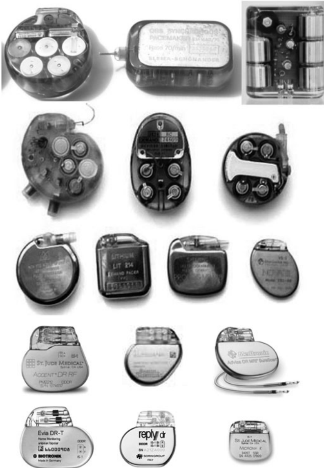
▣ Abb. 1.2 Entwicklung der Schrittmachergehäuse: von den Anfängen der Schrittmachertherapie bis 2010. Dieses Bild ist eine Fotomontage und zeigt nur ungefähre Größenverhältnisse. (Fotomontage wurde erstellt aus Schrittmachern der Firmen Biotronik, Boston, Intermedics, Medtronic, Sorin, St. Jude)
