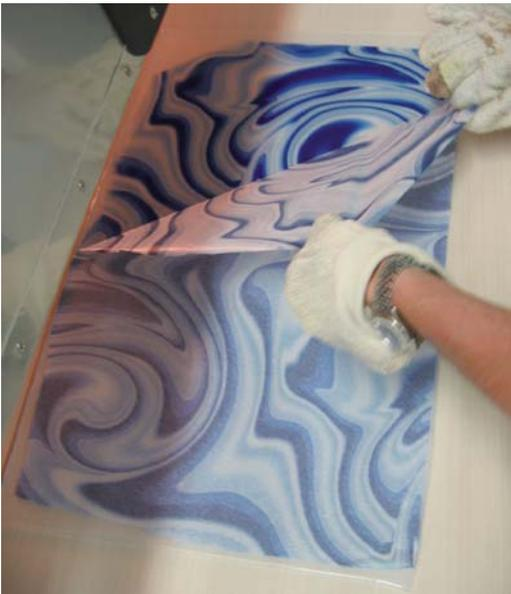
▣ **Abb. 6.** Durch Kontaktfärbepapier, das im thermoplastischen Zustand auf den Kunststoff aufgestrichen und nach einer kurzen Einwirkzeit wieder abgelöst wird, kann der Kunststoff ein zusätzliches Muster erhalten
