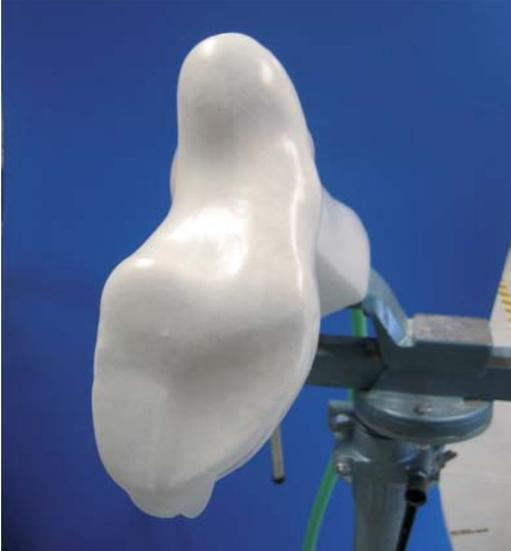
▣ **Abb. 4.** Durch das Vakuum legt sich der Kunststoff in die ausmodellierten Hinterschneidungen
