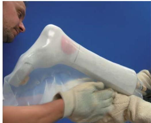
■ Abb. 3. Erste Anformung: der im Ofen erhitzte thermoplastische Kunststoff wird im Vakuumverfahren über das Modell angeformt. Beim Vakuumverfahren wird die Luft zwischen Modell und Kunststoff evakuiert. Das spätere Bauteil soll nur den Fuß komplett umschließen und wird daher aus einem nur 2 mm starken Polypropylen hergestellt
