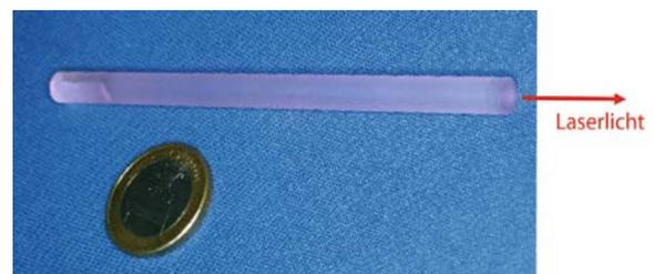
Abb. 2.6. Der Glasstab (Yttrium-Aluminium-Granat, YAG) enthält 1 %  $\text{Nd}^{3+}$ -Ionen, die die Stellen der Yttrium-Ionen im Kristall ersetzen. Dieser Glasstab mit einer Länge von ca. 10 cm und einer Dicke von ca. 1 cm ist dann das aktive Medium eines Nd:YAG Lasers. Unter optischer Anregung mit einer Blitzlampe emittieren die  $\text{Nd}^{3+}$ -Ionen Licht bei 1064 nm
